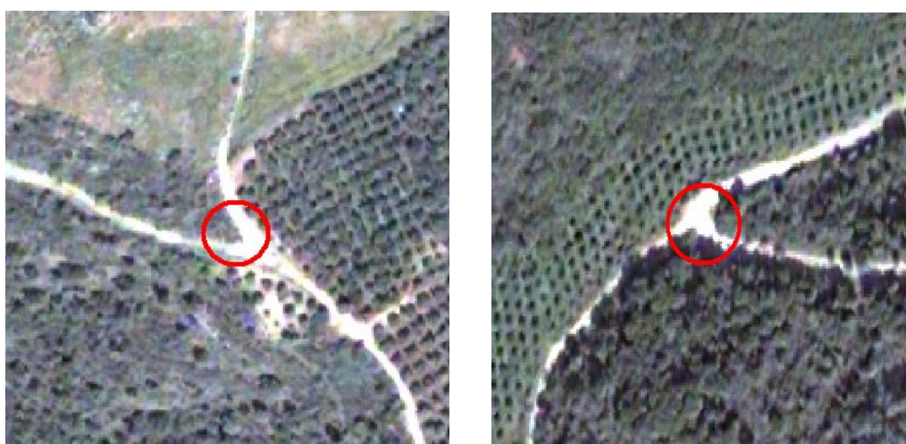
Εικόνα 3-6: Αναγνωρισιμότητα και ακρίβεια φωτοσταθερών σημείων
