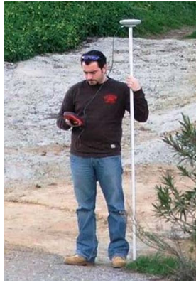
Εικόνα 3-9: Μετρήσεις στο πεδίο με το δορ. δέκτη Leica GS20 και το AX1201 Pole
