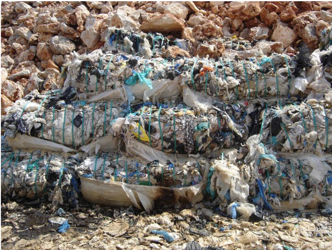
Εικόνα 20: Μερικά ακάλυπτα δεματοποιημένα απορρίμματα. Η ταινία περιτύλιξης όπως φαίνεται έχει καταστραφεί τελείως.
