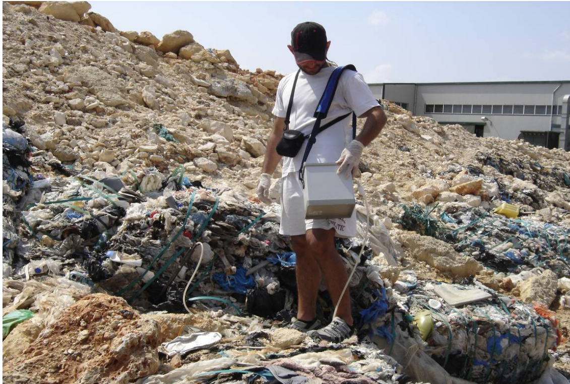
Εικόνα 43: Αφού έχει συνδεθεί το μηχάνημα, αναμένονται οι μετρήσεις, οι οποίες αργούν λίγο καθώς τα αέρια έχουν να δανείσουν μεγάλη απόσταση και η αντλία δεν πρέπει να δουλεύει με έντονους ρυθμούς για να μην ρουφάει χώμα.
