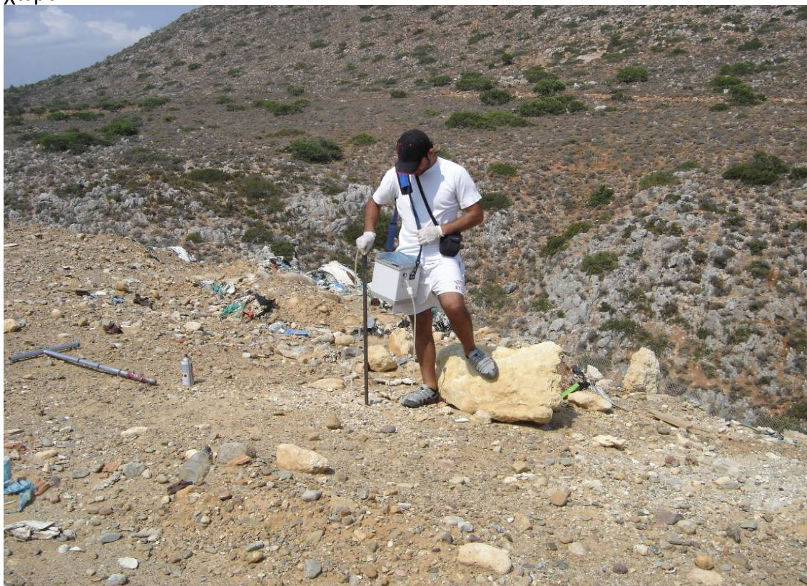
Εικόνα 44: Η ίδια διαδικασία πραγματοποιείται και όταν χρειαστεί να παρθούν μετρήσεις από ρωγμές, μόνο που το σίδερο δεν μπορεί να εισχωρήσει σε μεγάλα βάθη λόγω της μορφολογίας του εδάφους.
