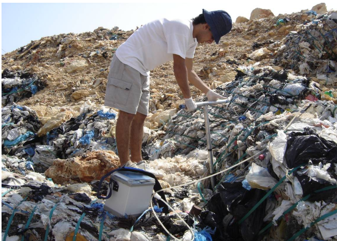
Εικόνα 41: Αρχικά για να είναι ευκολότερη η είσοδος του ατσάλινου σωλήνα στη μάζα των απορριμμάτων ή στο έδαφος μπορεί να χρησιμοποιηθεί ένα χειροκίνητο τρυπάνι για τη διάνοιξη μιας οπής στην οποία θα εισαχθεί ο σωλήνας. Το στάδιο αυτό δεν είναι απαραίτητο αν διαπιστωθεί ότι ο ατσάλινος σωλήνας μπορεί να εισχωρήσει στα σκουπίδια ή στο έδαφος μόνο με σπρώξιμο.
