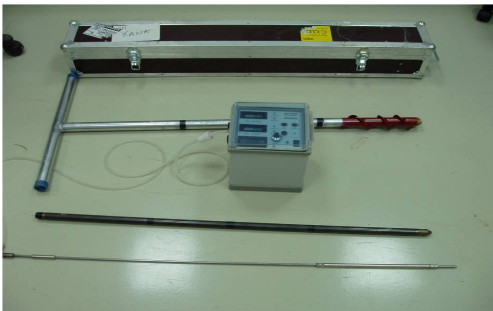
Σχήμα 40: Η διάταξη μέτρησης των εδαφικών αερίων
