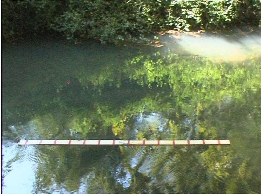
Εικόνα 3: Βαθμονομημένη σανίδα για μέτρηση επιφανειακής ταχύτητας
