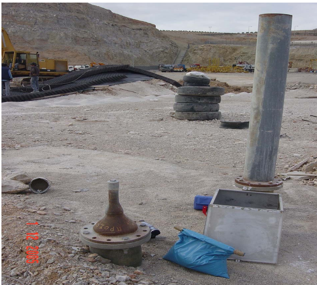
Εικόνα 17 - Σταθμός μέτρησης δονήσεων δίπλα από τον αγωγό ύδατος
