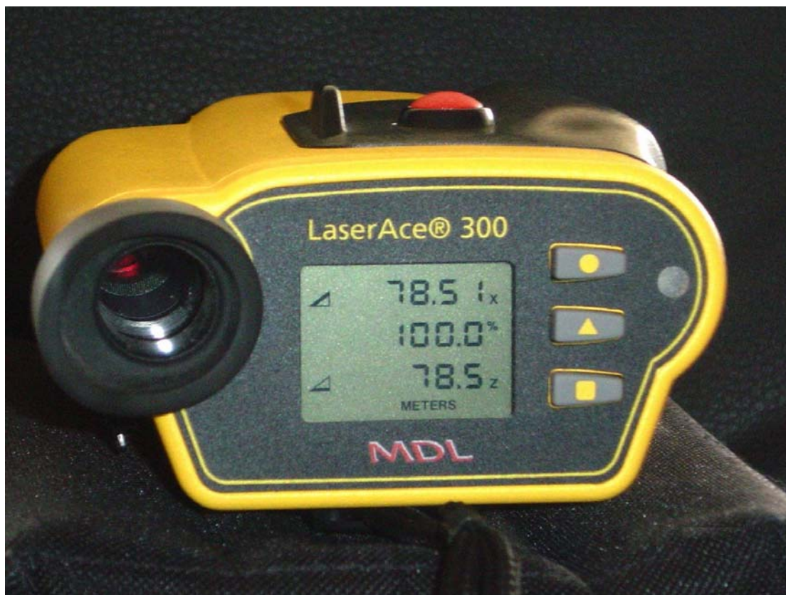
Εικόνα 34 - LaserAce300. Όργανο Laser που χρησιμοποιήθηκε για την άμεση μέτρηση των αποστάσεων και την αποτύπωση των σταθμών μέτρησης
