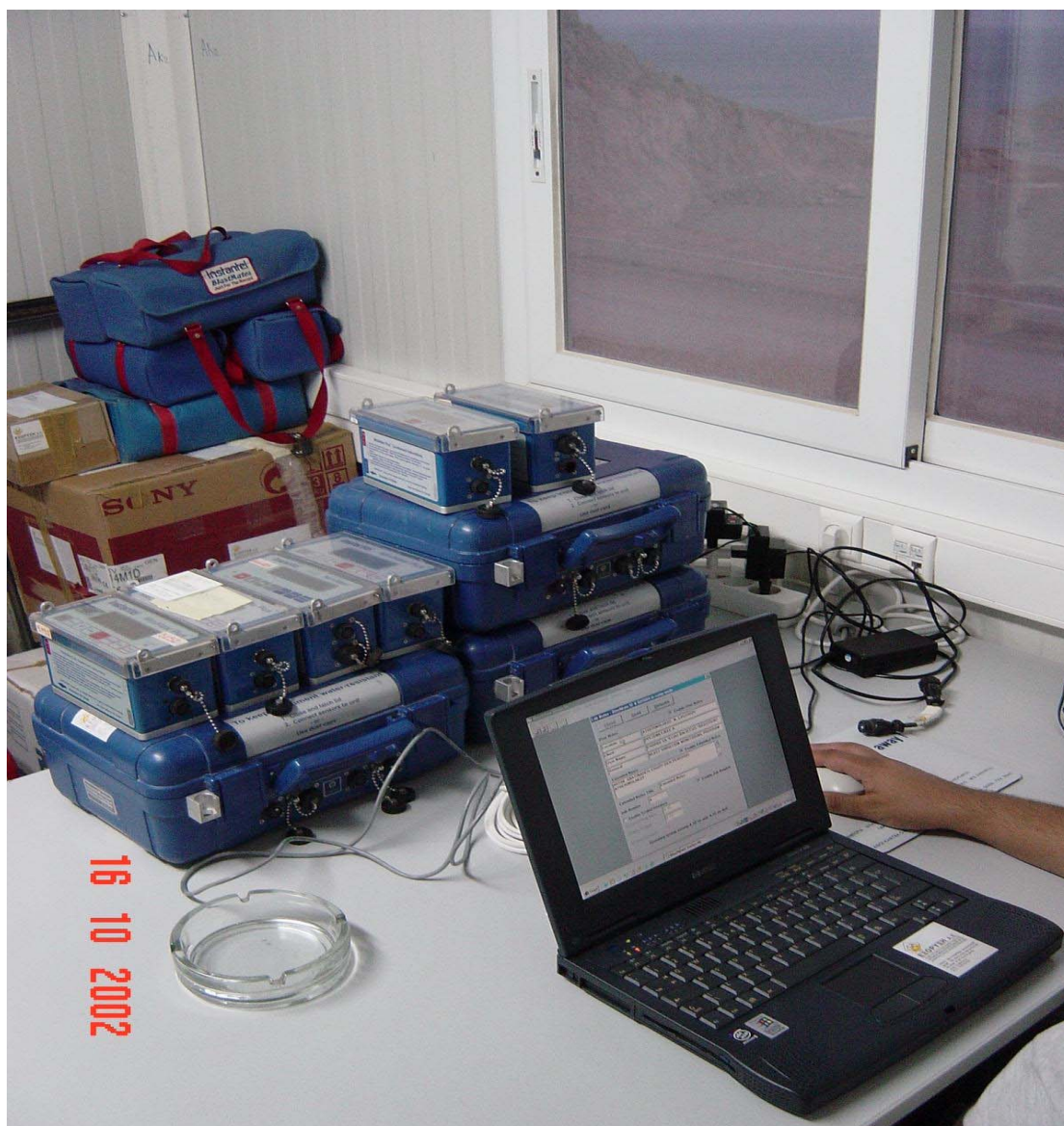
Εικόνα 7 – Δίκτυο σταθμών μέτρησης προγράμματος ελέγχου δονήσεων – υποστήριξη και υποδομή γραφείου
