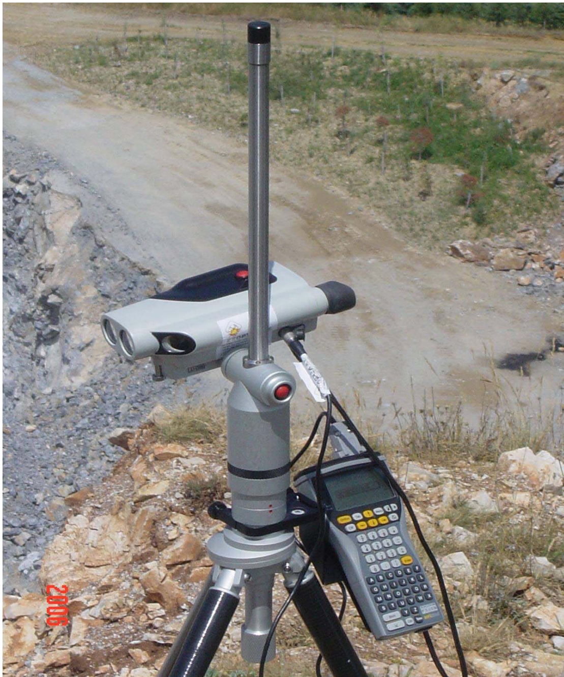
Εικόνα 33 - LaserAce300. Όργανο Laser που χρησιμοποιήθηκε για την άμεση μέτρηση των αποστάσεων και την αποτύπωση των σταθμών μέτρησης
