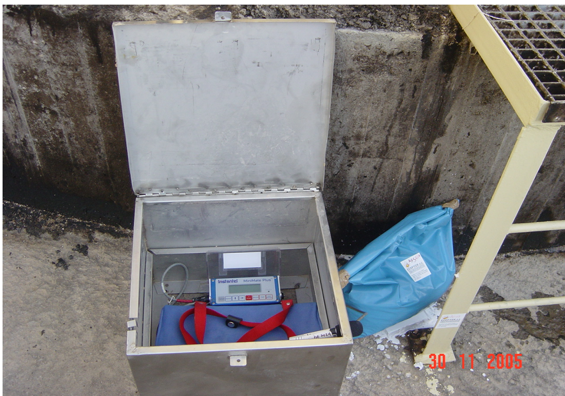
Εικόνα 18 - Σταθμός μέτρησης δονήσεων σε δεξαμενή λαδιού
