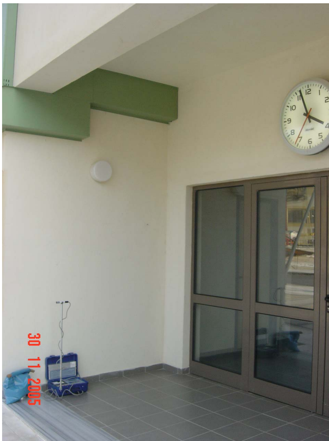
Εικόνα 21 - Σταθμός μέτρησης δονήσεων στο Κτήριο του Χημείου
