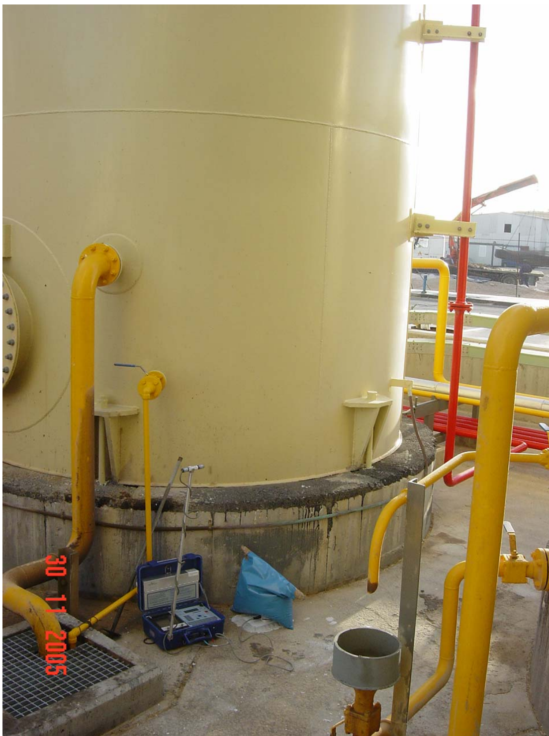
Εικόνα 19 - Σταθμός μέτρησης δονήσεων σε δεξαμενή λαδιού
