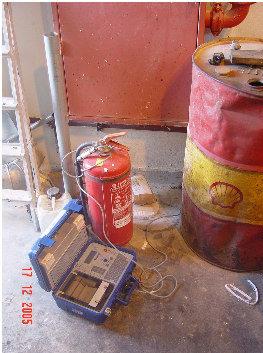
Εικόνα 23 - Σταθμός μέτρησης δονήσεων μέσα σε δεξαμενή καυσίμου
