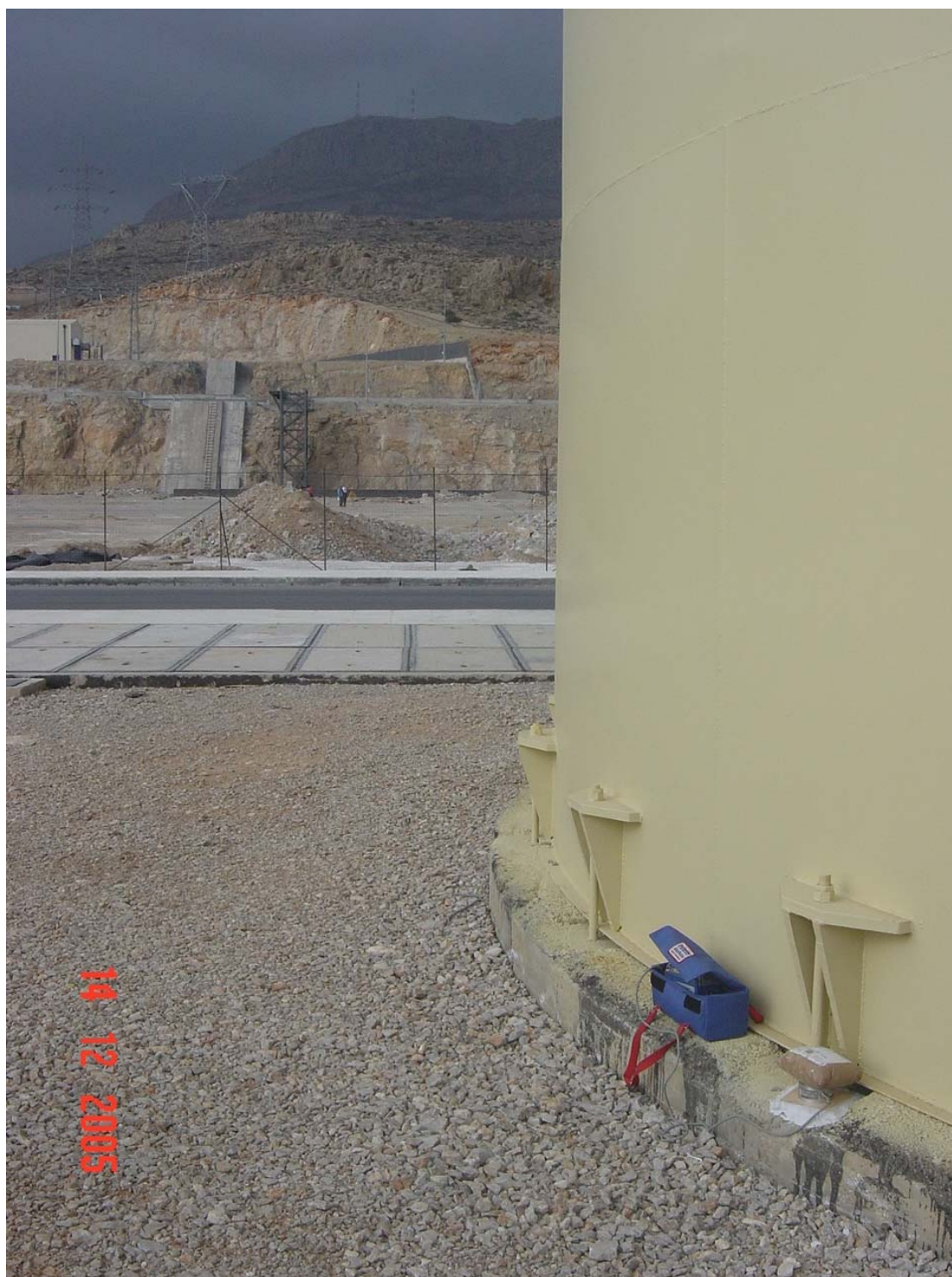
Εικόνα 22 - Σταθμός μέτρησης δονήσεων στις δεξαμενές ύδατος
