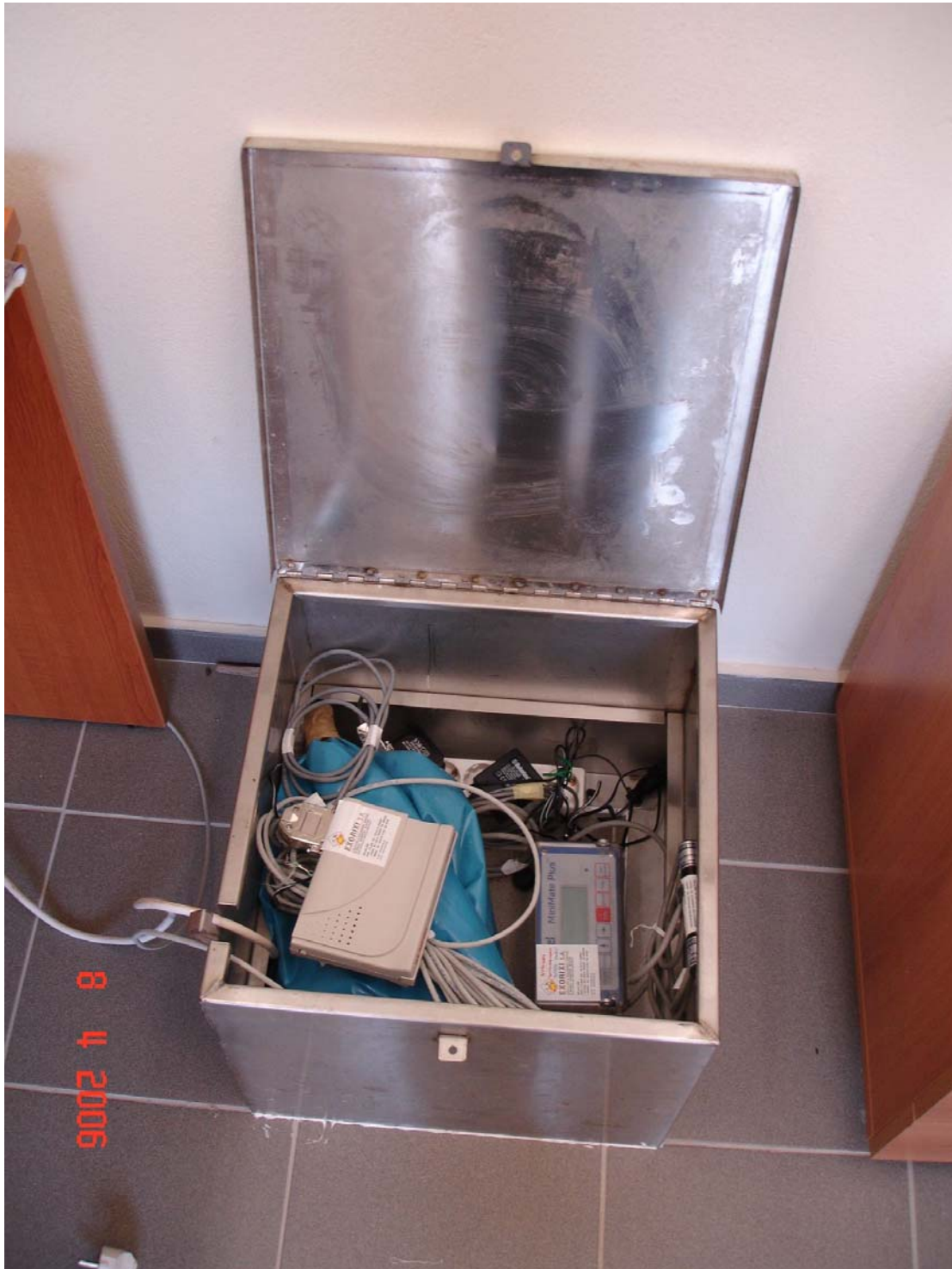
Εικόνα 24 - Ένας από τους δύο μόνιμα εγκατεστημένους σταθμούς μέτρησης, ο συγκεκριμένος στο Κτήριο του Χημείου, για συνεχή καταγραφή δονήσεων και επικοινωνία μέσω modem
