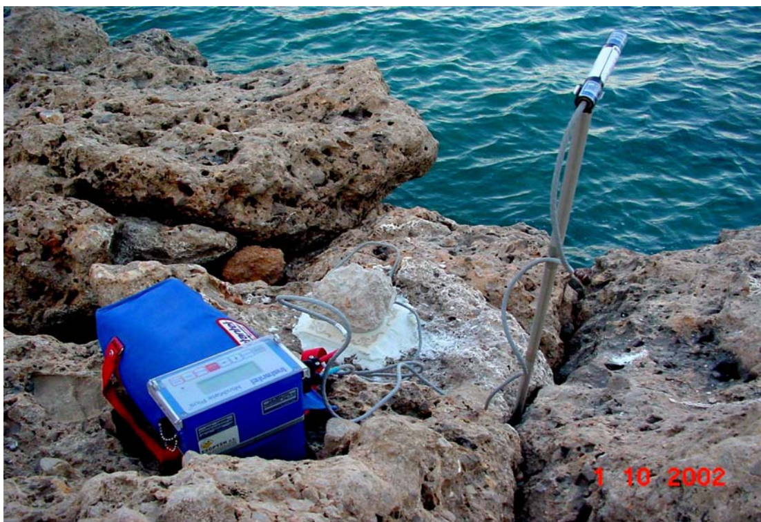
Εικόνα 6 – Σταθμός μέτρησης – ελέγχου δονήσεων
