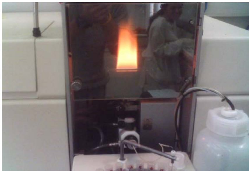
Εικόνα 3.2.2.2.α: Φώτο κατά την μέτρηση δειγμάτων στην Ατομική Απορρόφηση.
