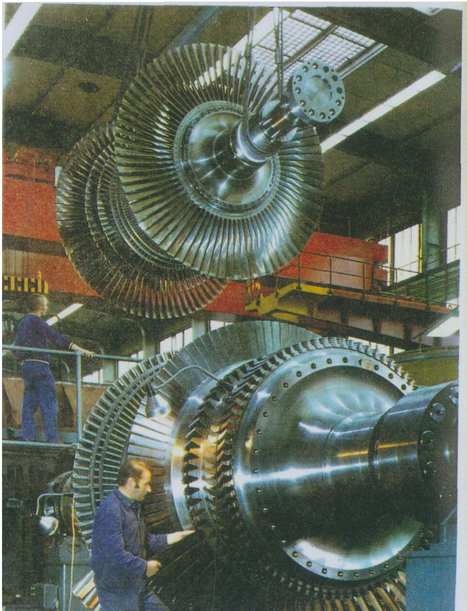
Σχ. 3. Στρεφόμενα πτερύγια στροβίλου. Πάνω είναι ο δρομέας μέσης και κάτω ο δρομέας χαμηλής πίεσης
