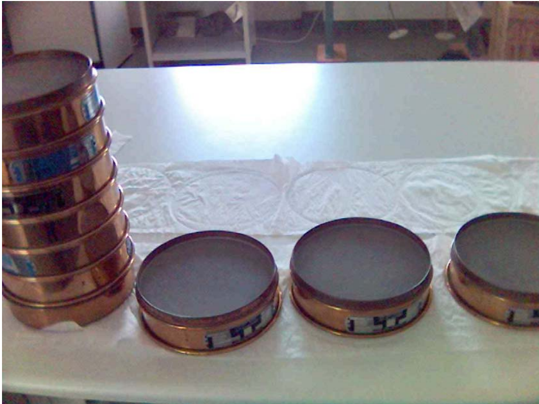
Εικόνα 5.4: Κόσκινα διαφορετικών διαμέτρων οπών που χρησιμοποιήθηκαν για την κοκκομετρική ανάλυση.
