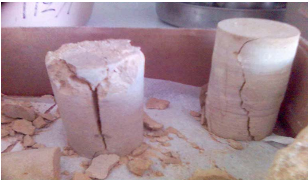
Σχήμα 5.7: Τα δοκίμια μετά την θραύση τους υπό μονοαξονική φόρτιση. Τα επίπεδα αστοχίας είναι εμφανή
