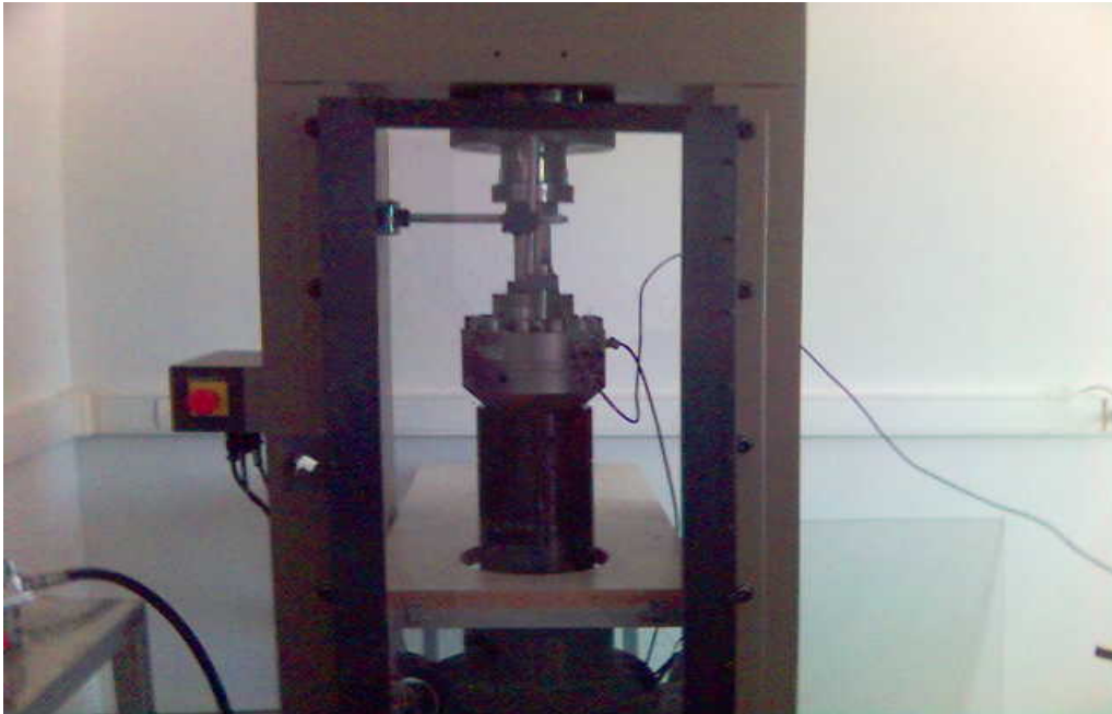
Εικόνα 5.6: Η συσκευή μονοαξονικής θλίψης που χρησιμοποιήθηκε για το πείραμα (MTS 1600).
