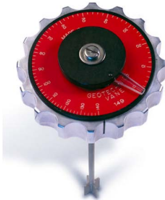
Εικόνα 5.3: Πρότυπο hand held vane test.
