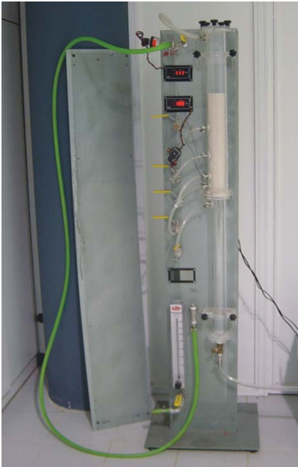
Εικόνα 3.3 Προσομοίωση αντιδραστήρα ρευστοποιημένης κλίνης (κρύο μοντέλο)
