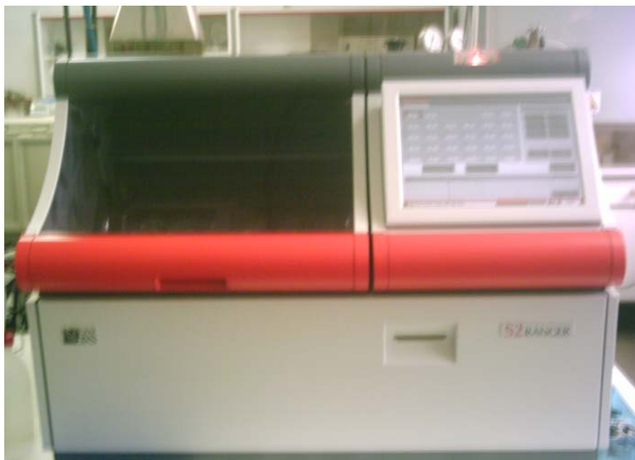
Εικόνα 3.4 : Φασματοφωτομετρικός αναλυτής S2 RANGER της BRUKER.
