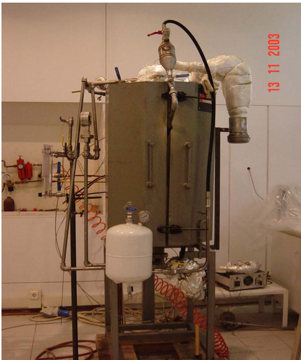
Εικόνα 3.2 Πειραματική διάταξη συστήματος ρευστοποιημένης κλίνης που χρησιμοποιήθηκε στη παρούσα εργασία.
