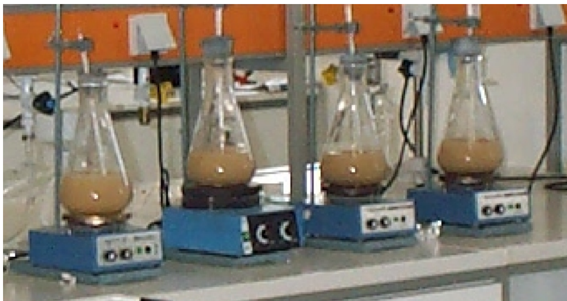
Εικόνα 3.1 Πειραματική διάταξη της διεργασίας της εκχύλισης
