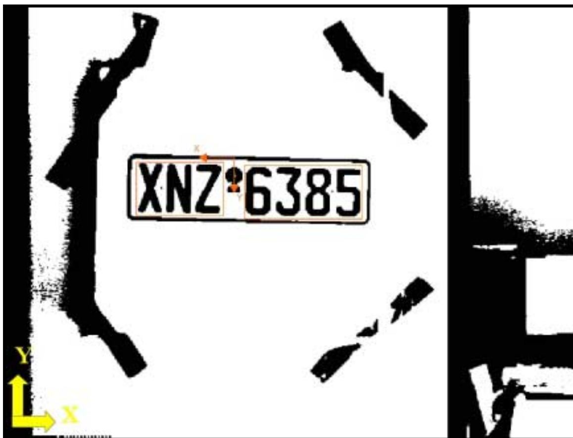
Σχήμα 4.4: Το νέο σύστημα συντεταγμένων και το σύστημα συντεταγμένων της κάμερας.
