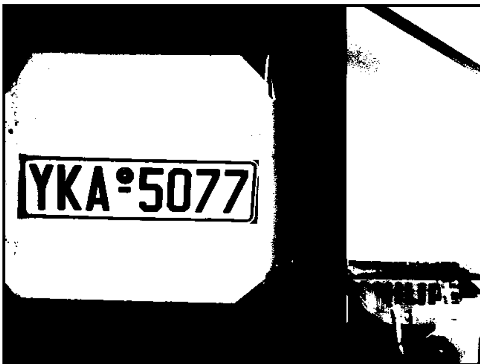
Σχήμα 3.21: Απομάκρυνση θορύβου με τη συνέλιξη βαθυπερατού φίλτρου.
