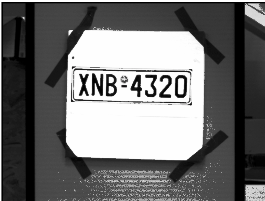
Σχήμα 8.6: Περιστροφή -10^\circ ως προς τον Y ( z=0 , κλίση -10^\circ ως προς Y ).
