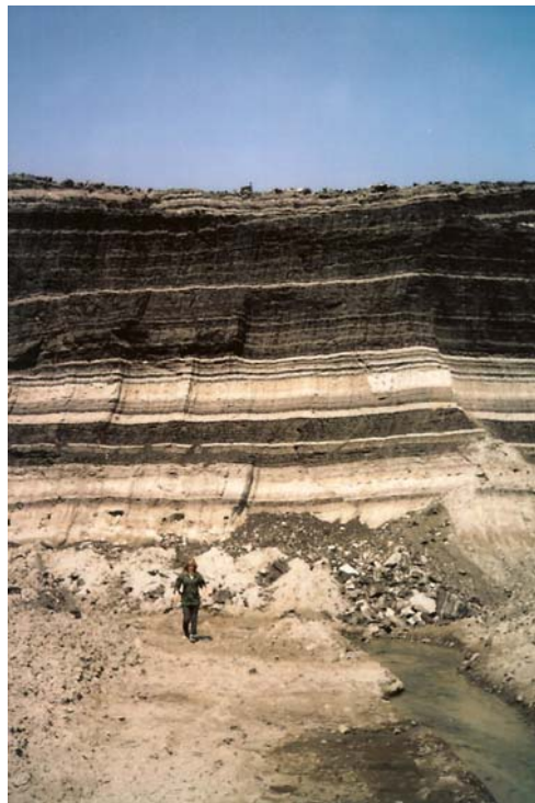
Σχήμα Β.2: Λιγνιτικά κοιτάσματα τύπου “ζέβρα”.
