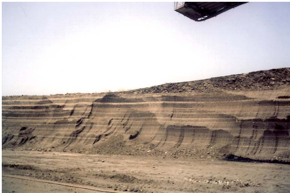
Σχήμα Β.3: Εναλλαγές λιγνιτικών στρωμάτων με στρώματα πολύ ισχυρώς ανθρακομιγής μάργας.
