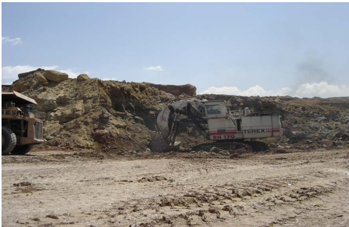
Εικόνα 4.6: Μηχανικό πτύο μετωπικού κάδου Terex O&K RH 170.
