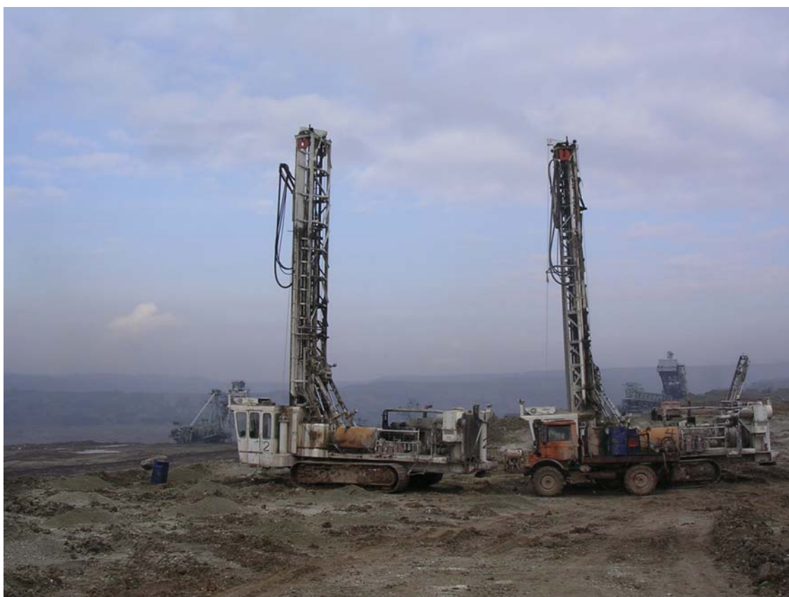
Εικόνα 4.8: Διατρητικό φορείο Tamrock C 50 K 3L.
