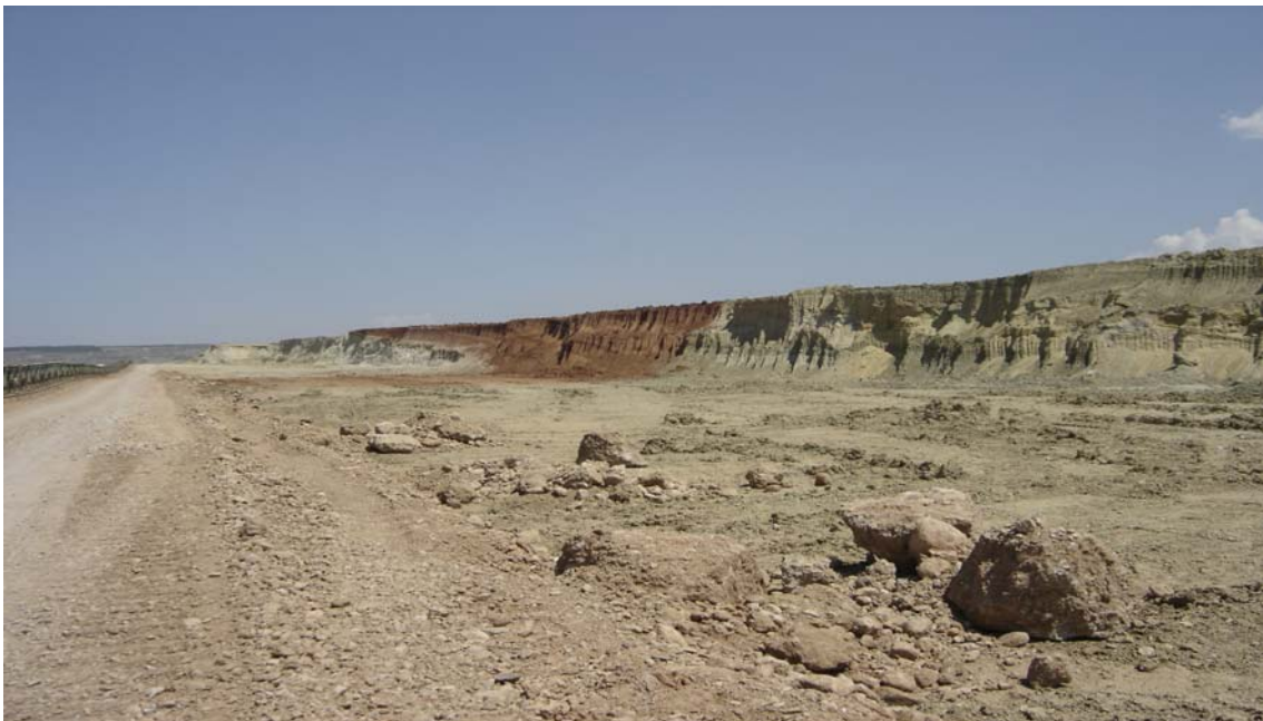
Εικόνα 3.1: Εναλλαγή γκριζοπράσινης αργίλου, καστανέρυθρης αργίλου και σκληρού σχηματισμού πλειστόκαινου.
