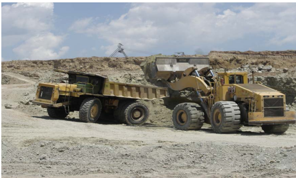
Εικόνα 4.5: Ελαστιχοφόρος φορτωτής κατά τη διαδικασία φόρτωσης.
