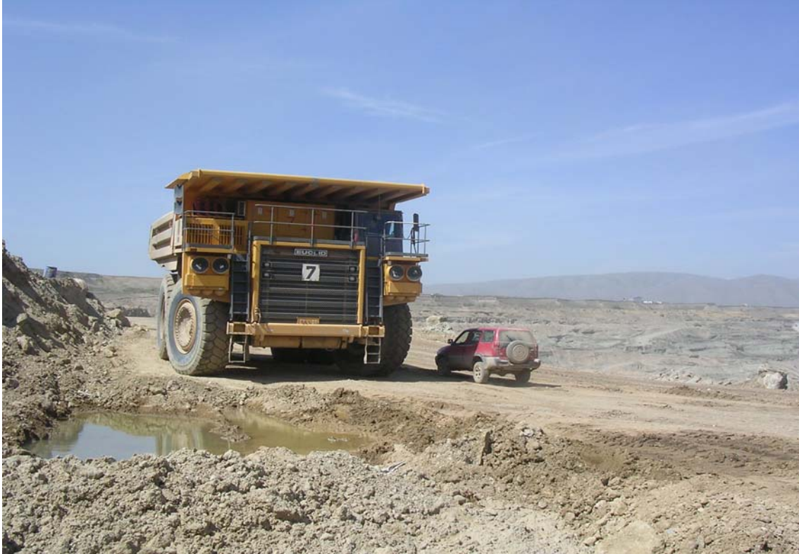
Εικόνα 4.7: Χωματουργικό όχημα Euclid-Hitachi EH3500 192 ton.
