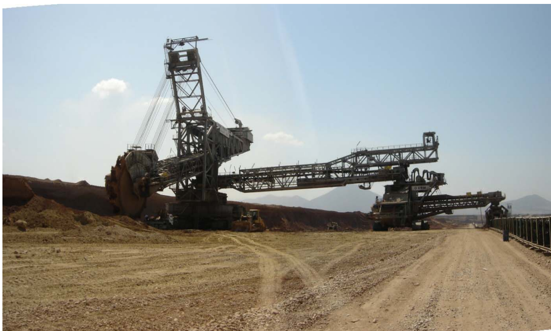
Εικόνα 4.1: Καδοφόρος εκσκαφέας, μονάδα φόρτωσης, τομοταινία.
