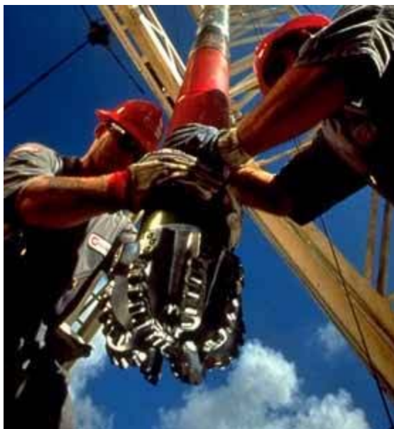
Σχήμα 2.11. Καθέλκυση του γεωτρύπανου στην γεώτρηση.
