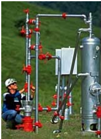
Σχήμα 2.17. Το «χριστουγεννιάτικο δέντρο».
