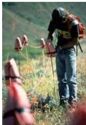
Σχήμα 2.3. Τοποθέτηση γεωφώνων για την καταγραφή τεχνητών σεισμικών δονήσεων.
