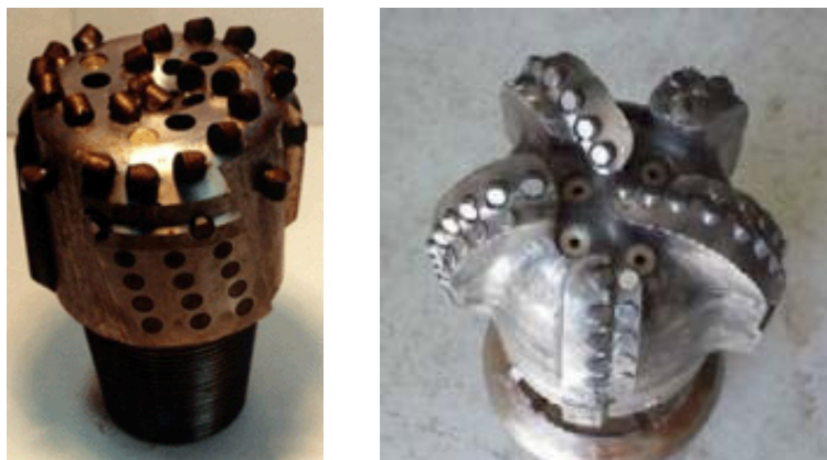
Σχήμα 2.12. Κοπτικά εργαλεία περιστροφικής διάτρησης.
