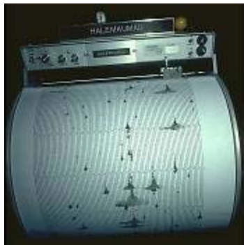
Σχήμα 2.2. Σεισμογράφος, όργανο για την ανίχνευση και καταγραφή σεισμικών δονήσεων.
