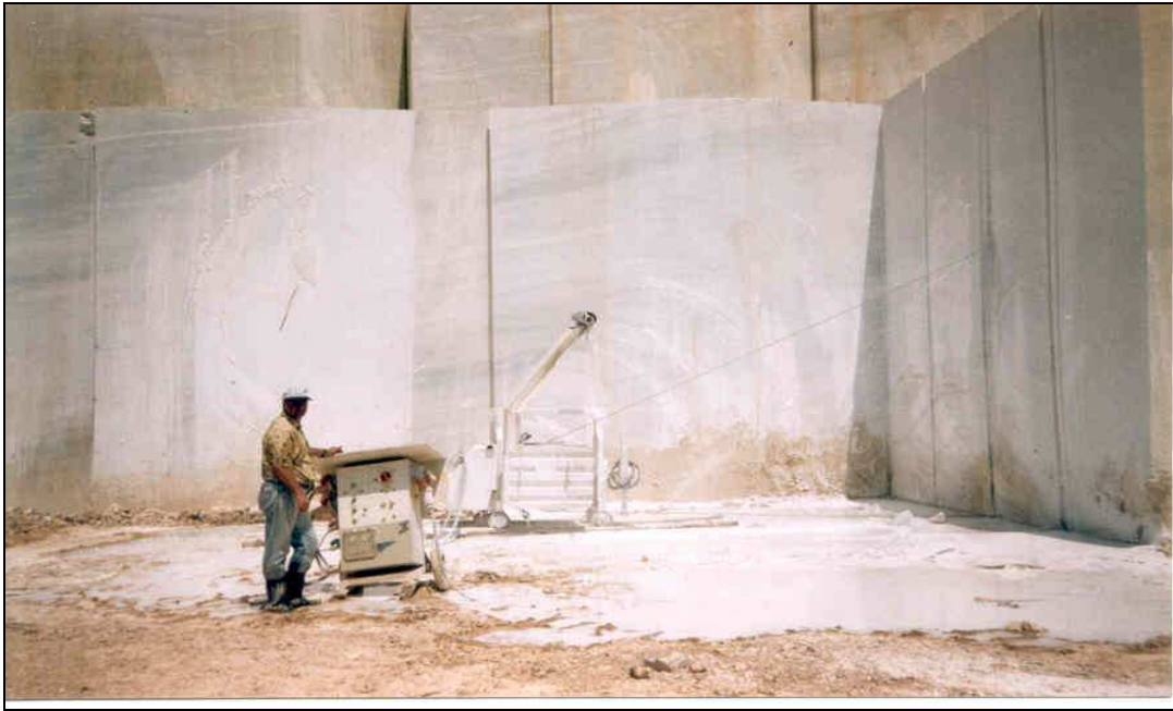
Εικόνα 2.3: Εξόρυξη με συρματοκοπή
