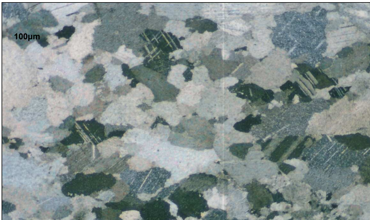
Εικόνα 5.5: β) Τομή δείγματος Β από πολωτικό μικροσκόπιο με x (διασταυρωμένα) Nicols (ασβεστιτικό μάρμαρο που αποτελείται από κρυστάλλους ασβεστίτη με ταινιωτή διδυμία, φυλλάρια μοσχοβίτη και κόκκους χαλαζία)
