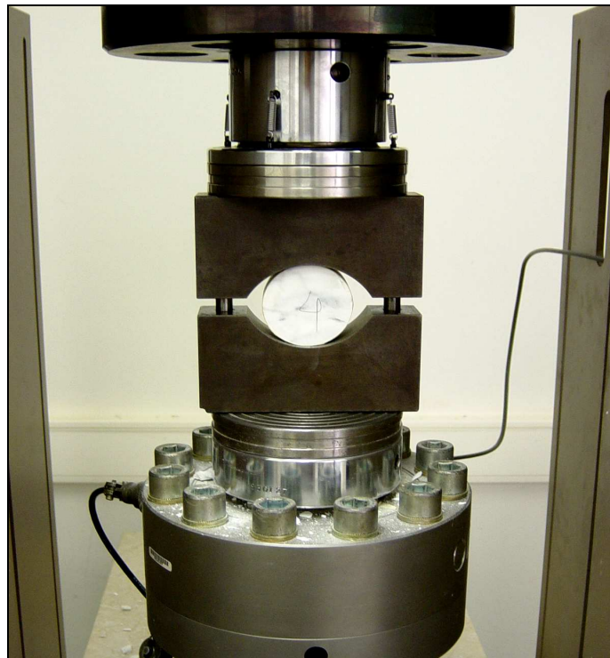
Εικόνα 5.14: Σύστημα δοκιμής σε έμμεσο εφελκυσμό
