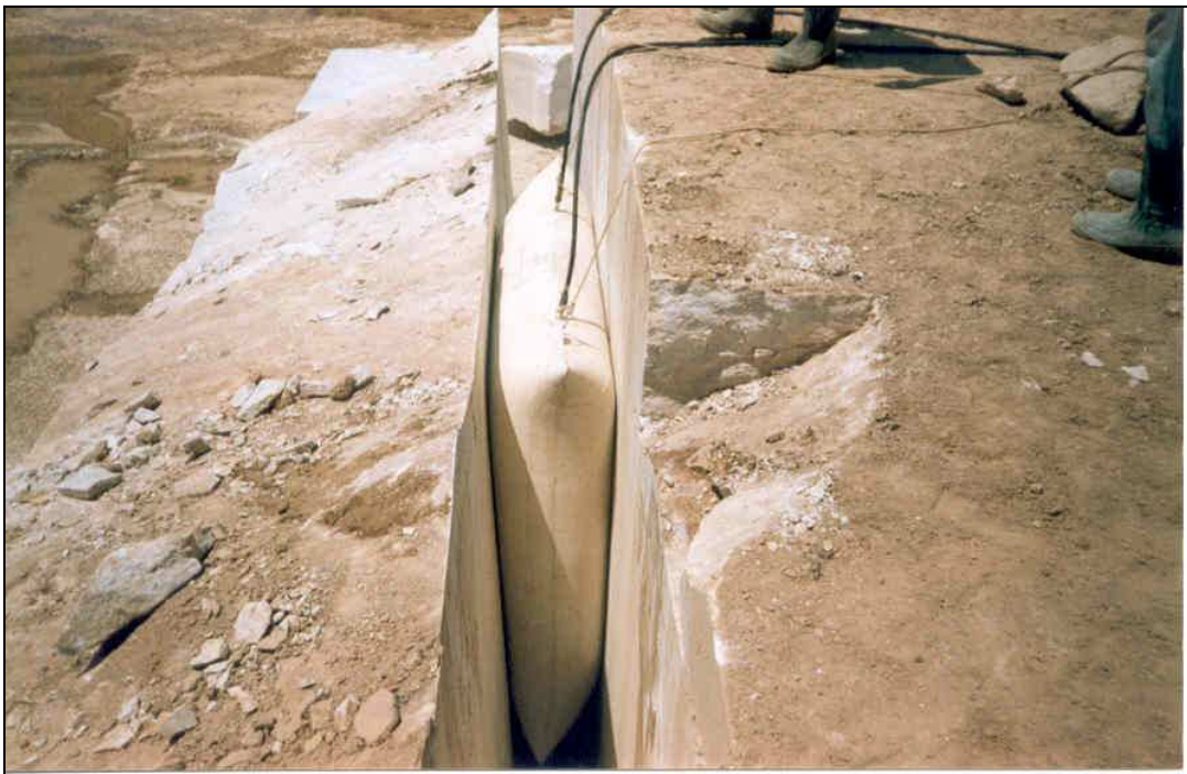
Εικόνα 2.4: Αποχωρισμός ογκομαρμάρου από μητρικό πέτρωμα
