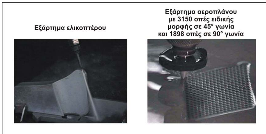
Σχήμα 2.5 : Water-jet στην αεροπορική βιομηχανία
