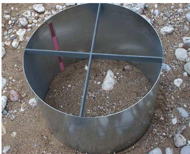
Φωτογραφία 5.2: Η συσκευή που χρησιμοποιήθηκε για τα πειράματα της διηθητικής ικανότητας στο πεδίο
