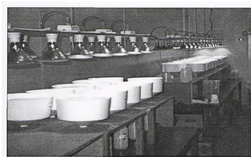
Σχήμα Ε1. Προετοιμασία δοκιμής εκχύλισης σε στήλες ελεύθερης απορροής με συμβατικά χωνιά Buchner (ARD Test Handbook, 2002)
