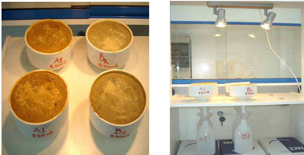
Σχήμα 4.11. Πειραματική διάταξη με βάση το πρωτόκολλο AMIRA
