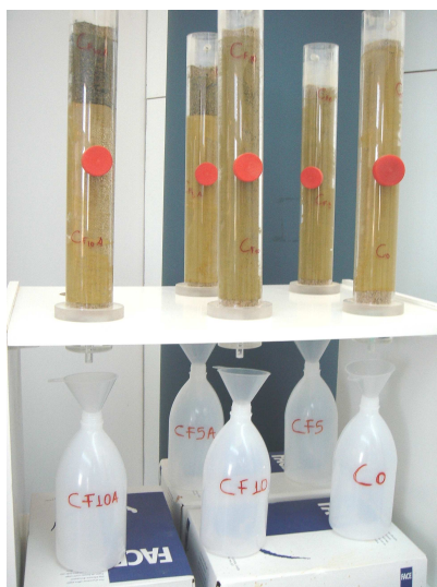
Σχήμα 4.12. Πειραματική διάταξη σταθεροποίησης αποβλήτων σε εργαστηριακές στήλες (C0, CF5, CF5A, CF10, CF10A) με παράλληλη συλλογή εκχυλισμάτων
