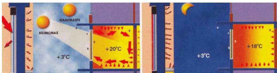
Σχήμα 3.3: Έμμεση αποθήκευση της ηλιακής ενέργειας σε τοίχο μάζας.
