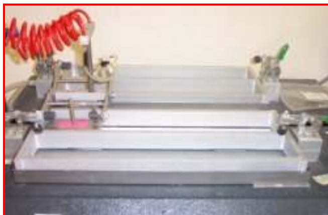
Εικ. 4.6 : Συσκευή που γίνεται η μέτρηση της αντίστασης σε απότριψη εν υγρώ.
