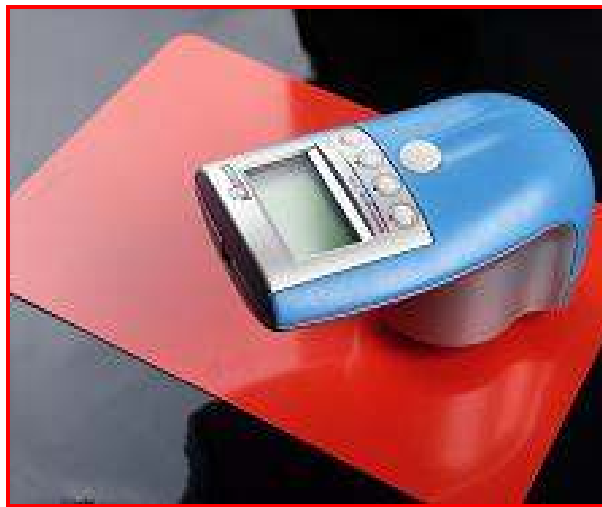
Εικ. 4.5 : Όργανο που μετράει την γυαλάδα του φιλμ χρώματος. (Πηγή : www.bykgardner.com )
