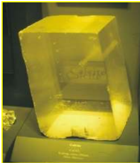
Εικ. 1.3 : Ασβεστίτης (ισλανδική κρύσταλλος) εμφανίζει διπλή διάθλαση.
