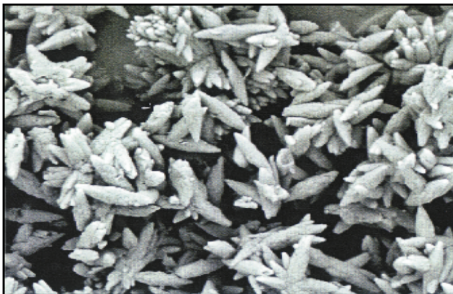
Εικ. 5.6 : Φωτογραφία PCC από ηλεκτρονικό μικροσκόπιο.
