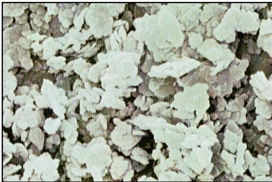
Εικ. 5.9 : Φωτογραφία καολίνη από ηλεκτρονικό μικροσκόπιο. (Πηγή : OMYA S.A)
