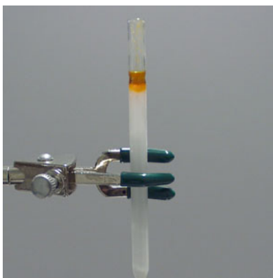
Εικόνα 8.8 Έναρξη διαδικασίας διαχωρισμού, μόλις έχει γίνει εισαγωγή του δείγματος στη στήλη.
