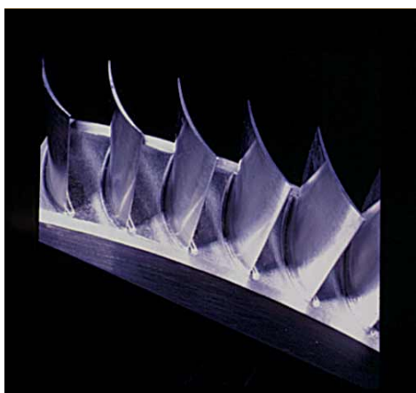
Εικόνα 1.18. Φυγόκεντρη πτερωτή με τη χρήση του Vista-AC Blade[15]
