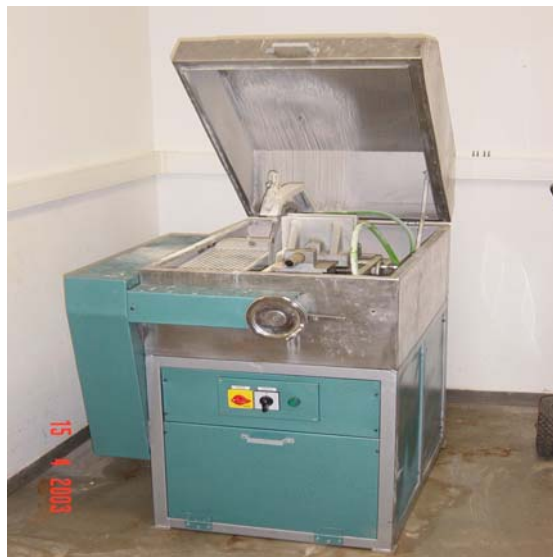
Σχήμα 3.1: Αδαμαντοφόρος δίσκος κοπής
