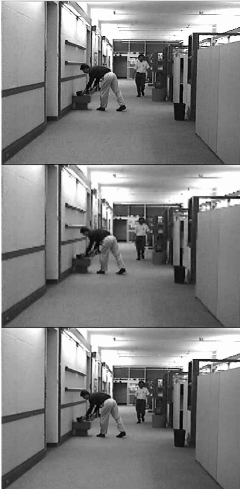
Σχήμα 33. Παραγωγή του καρτέ 119 (Hall) με ενισχυμένα διανύσματα κίνησης, Γνήσιο καρτέ, Γραμμική παρεμβολή, Επαναληπτικός αλγόριθμος
