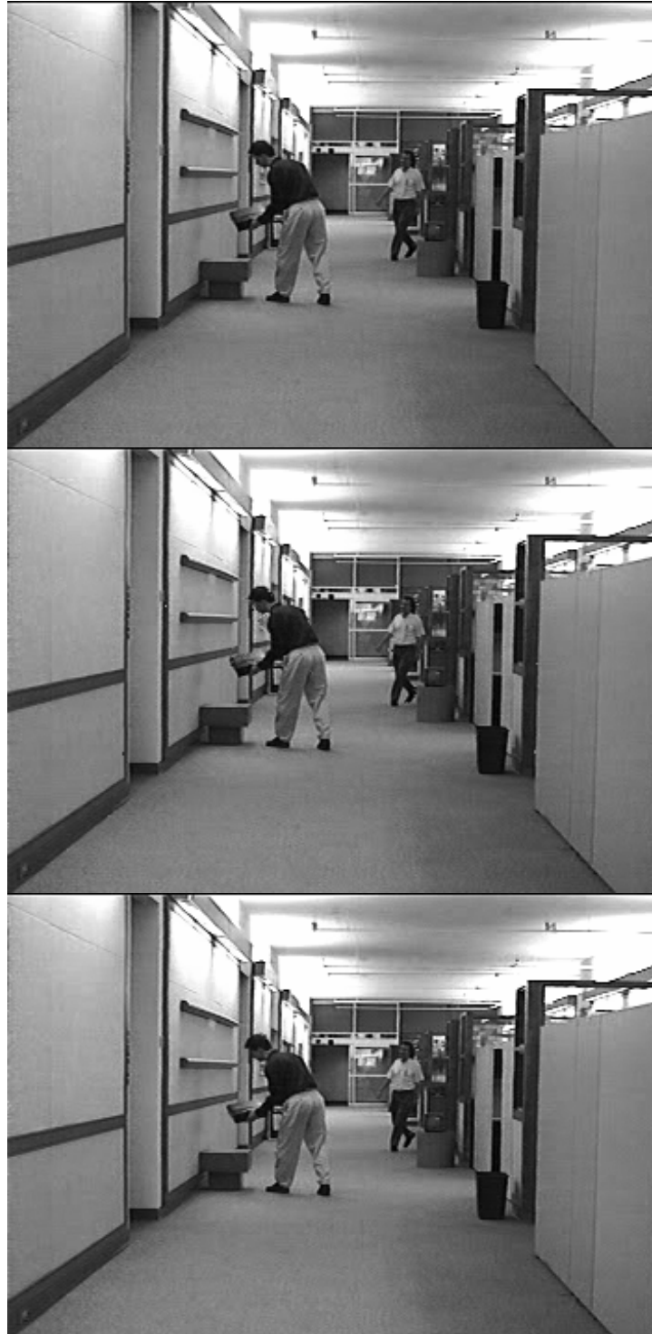
Σχήμα 34. Παραγωγή ενδιάμεσου καρέ (Hall) με motion scaling κατά 1/4 , Γνήσιο καρέ 98, Ενδιάμεσο καρέ εξόδου, Γνήσιο καρέ 99
