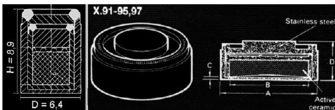
Εικόνα 2.9 : Σχηματική αναπαράσταση της μορφής των δύο πηγών
