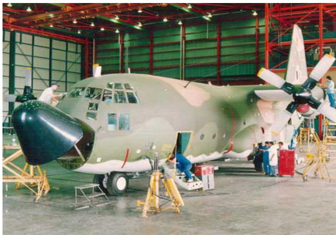
Εικόνα 1.2 Προγραμματισμένη Συντήρηση Αεροσκάφους στις εγκαταστάσεις της Επιχειρηματικής Μονάδας Συντήρησης Αεροσκαφών
