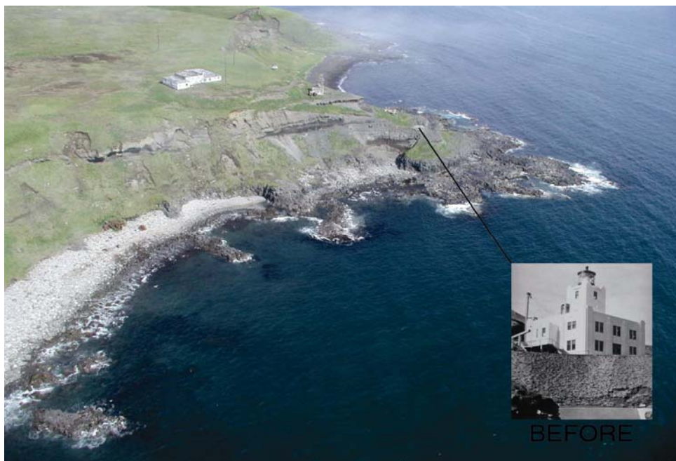
Σχήμα 2.3. Scotch Cap, Unimak, Αλάσκα. Ο φάρος ήταν εκεί που δείχνει το βέλος. Το κύμα έφτασε τα 42m στο σημείο αυτό του ακρωτηρίου. Ο φάρος καταστράφηκε πλήρως και πέντε άνθρωποι σκοτώθηκαν. (Πηγή: Synolakis, [2003])
