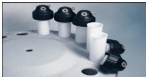
Εικόνα 46: Τα vessel με δείγματα και το vessel αναφοράς με τον αισθητήρα, τοποθετημένα μέσα στο ρότορα.
