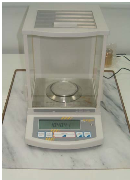
Εικόνα 38: Ψηφιακή ζυγαριά ακριβείας
