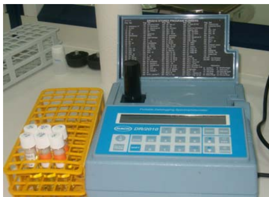
Εικόνα 23 Φασματοφωτόμετρο της εταιρίας Hach που χρησιμοποιήθηκε για τις μετρήσεις των φωσφορικών
