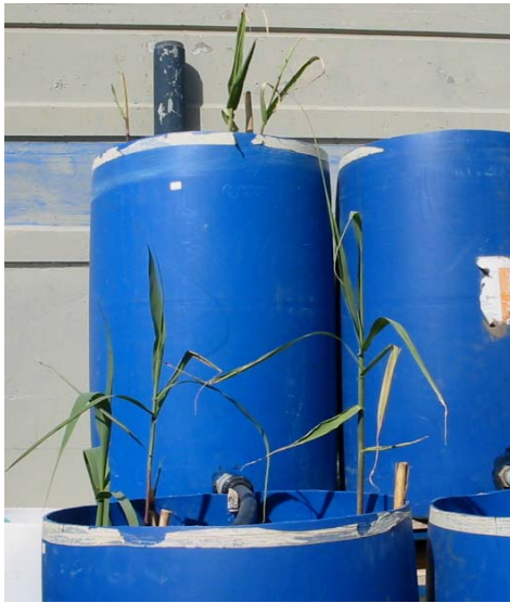
Εικόνα 5.7.2 - Ο τεχνητός υδροβιότοπος στις 28/03 μετά από 20 μέρες τροφοδοσίας με νερό και λίπασμα
