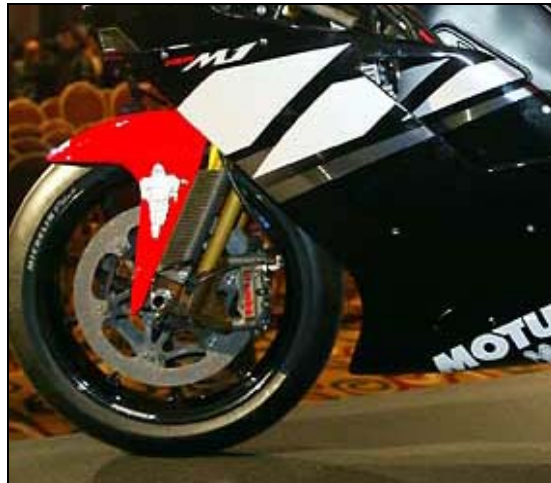
Σχήμα 3.2.1.1: Τυπικό εμπρός σύστημα πέδησης αγωνιστικής μοτοσυκλέτας ( www.moto-live.com ).
