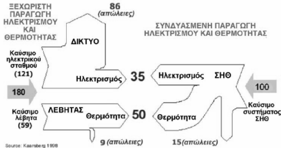
Σχήμα 2.2: Συμβατικό ενεργειακό σύστημα σε σύγκριση με σύστημα συμπαραγωγής. (Τα νούμερα αναφέρονται στις ενεργειακές μονάδες που προσφέρονται από το καύσιμο, που απωλείονται στο περιβάλλον και που τελικά μετατρέπονται σε αξιοποιήσιμη ενέργεια.)
