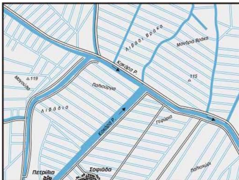
Σχήμα 6.8. Δίκτυο τάφρων (αποστραγγιστικών) στην περιοχή Σοφιάδας (όρια Φθιώτιδας-Καρδίτσας) που μπορεί να χρησιμοποιηθεί για τεχνητό εμπλουτισμό. [Σούλιος, 2004]
