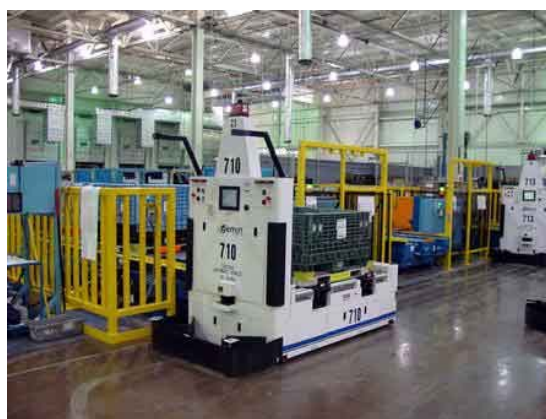
Εικόνα 3.2.1.2: AGV με LASER
