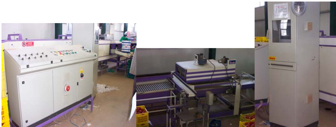
Διαλογητήριο OLIMPIAS-κονσόλα ελέγχου-ετικεταδόρος-υπολογιστής
