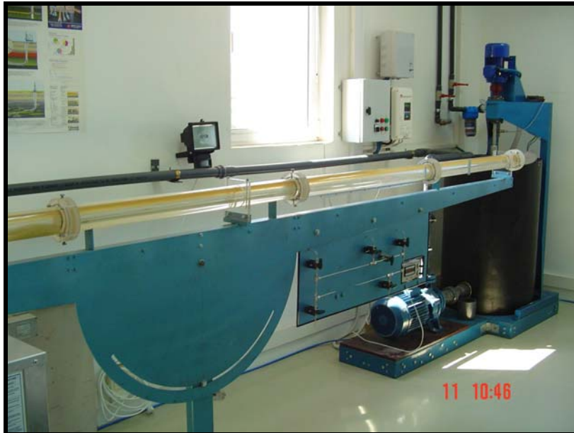
Εικόνα 2.1. Ο δακτύλιος και η βάση στήριξης και περιστροφής
