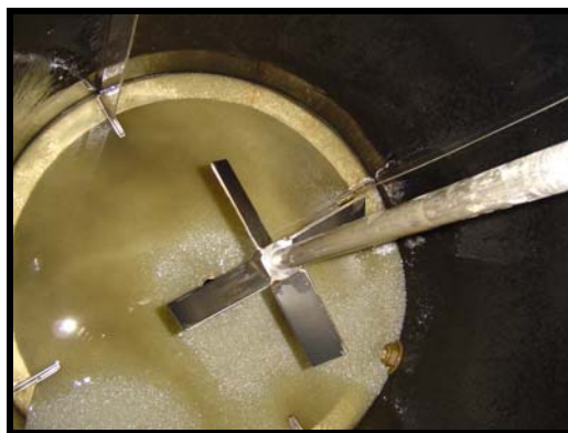
Εικόνα 2.3. εσωτερικό δεξαμενής με τον αναδευτήρα και ποσότητα στερεών
