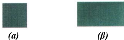
Εικόνα 4.5: Δημιουργία ενός ορθογώνιου παραλληλογράμμου(β) από ένα τετράγωνο(α), χρησιμοποιώντας παράγοντες αλλαγής κλίμακας s_x=2 και s_y=1 [3].
