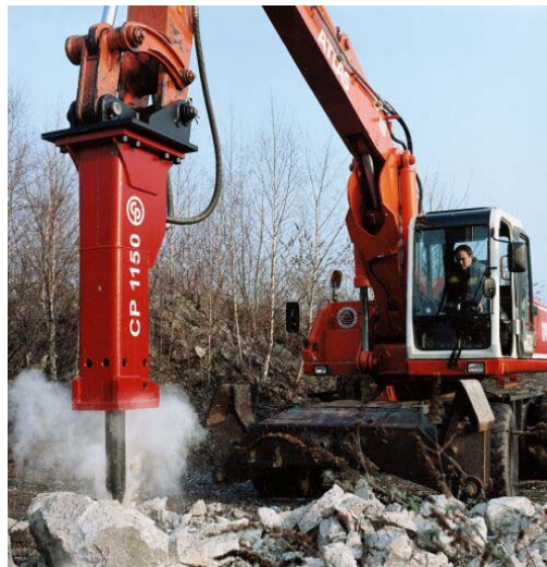
Σχήμα 2.14: Σφύρα εκσκαφής μαλακών και αποσαθρωμένων σχηματισμών ( www.atlascopco.com 2004).
