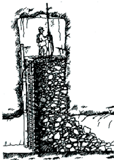
Σχήμα 3.6: Παρουσίαση μεθόδου συμπτυσσόμενου μετώπου.
