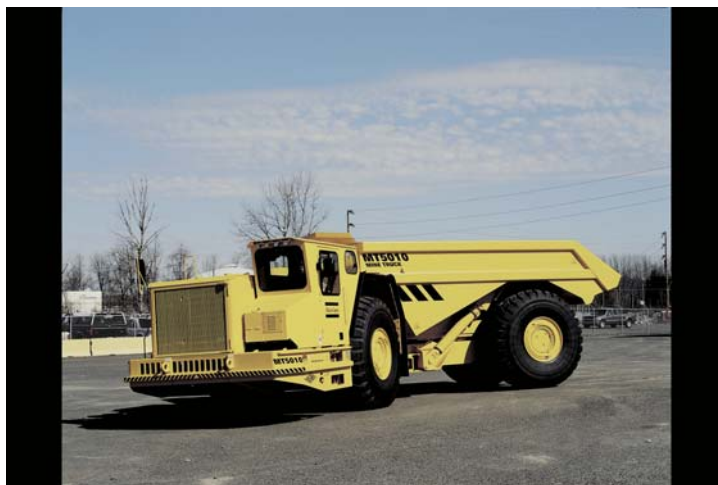
Σχήμα 2.8β: Όχημα μεταφοράς τύπου Wagner MT5010 του θρυμματισμένου υλικού ( www.atlascopco.com 2004).
