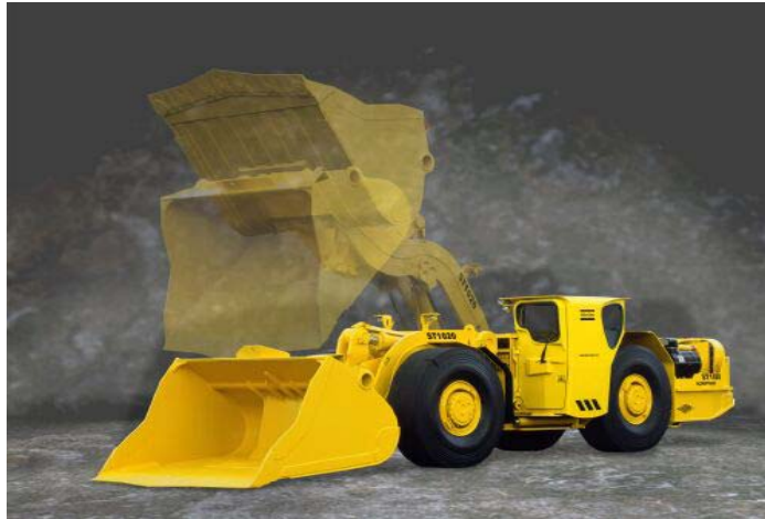
Σχήμα 2.8α: Όχημα φόρτωσης τύπου ST1020, για το θρυμματισμένο υλικό της ανατίναξης ( www.atlascopco.com 2004).
