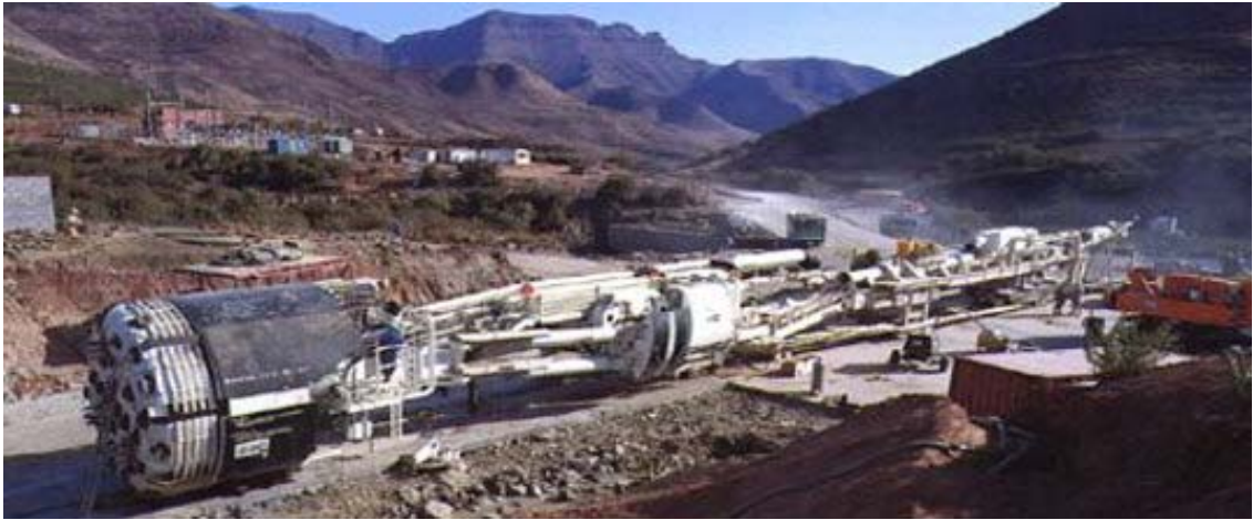
Σχήμα 2.1: Μηχάνημα Ολομέτωπης Κοπής, στην πλήρη ανάπτυξή του ( www.robbinstbm.com 2004).
