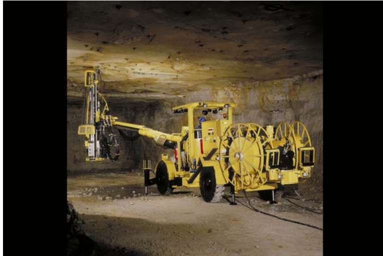
Σχήμα 2.9β: Μηχάνημα τοποθέτησης των αγκυρίων ( www.atlascopco.com 2004).
