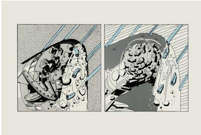
Σχήμα 2.13: Υποστήριξη με αγκύρια Swellex και εκσκαφή με ΜΟΚ και ΜΣΚ ( www.atlascopco.com 2004).
