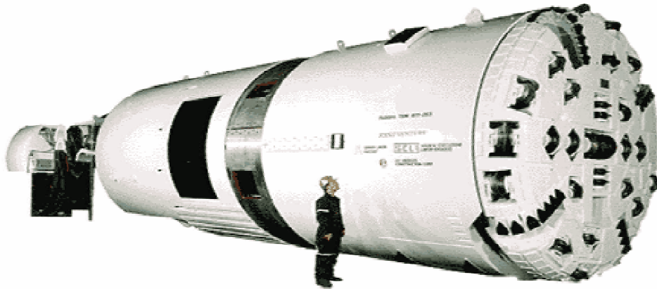
Σχήμα 2.2: ΜΟΚ με ασπίδα ( www.robbinstbm.com 2004).
