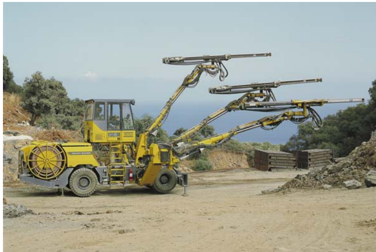
Σχήμα 2.6: Διατρητικό μηχάνημα Τύπου Rocket Boomer (www.atlascopco.com 2004).
