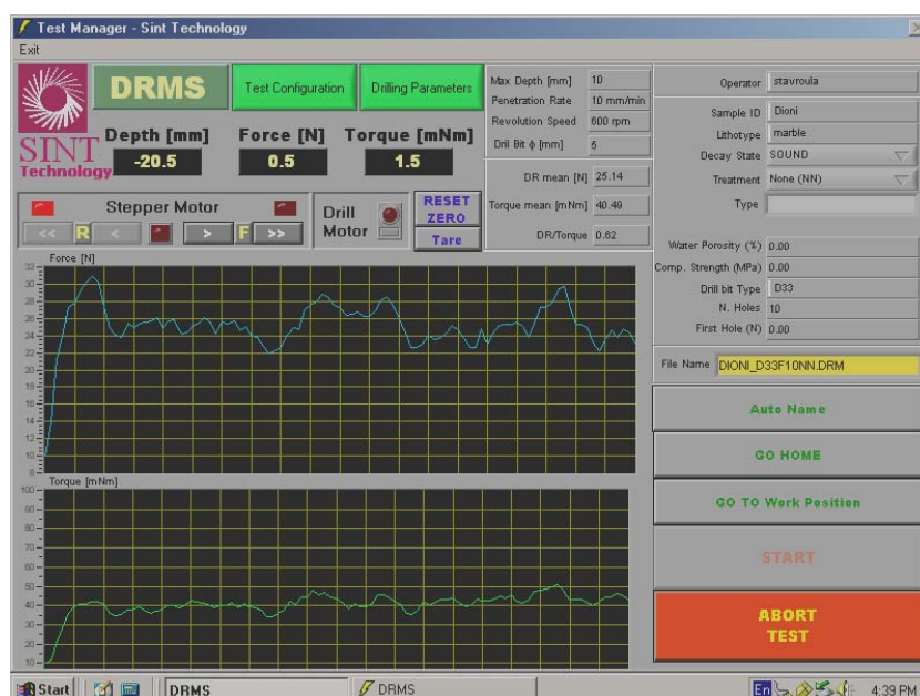
Σχ. 2.4. Οθόνη του φορητού ηλεκτρονικού υπολογιστή για την αυτόματη λειτουργία του DFTMS. Παράδειγμα καταγραφής της αξονικής δύναμης διάτρησης και της ροπής περιστροφής συναρτήσει του βάθους κοπής κατά τη διάρκεια δοκιμής.
