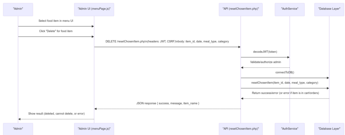
Εικόνα 50: Sequence Diagram που παρουσιάζει την αλληλεπίδραση μεταξύ διαχειριστή και συστατικών του συστήματος κατά τη δήλωση του μενού της ημέρας.
