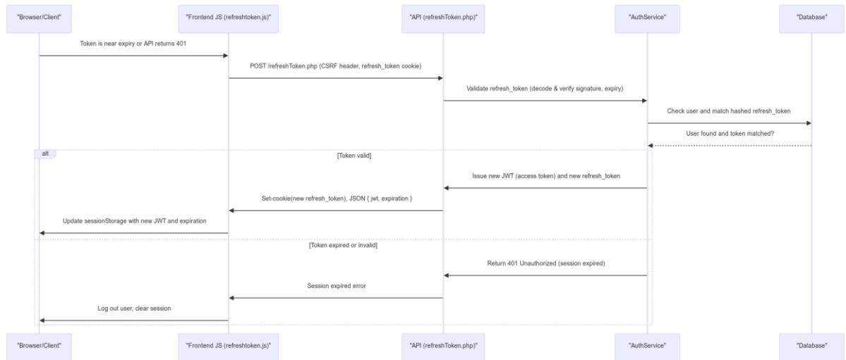
Εικόνα 42: Sequence Diagram που παρουσιάζει την αλληλεπίδραση μεταξύ συστατικών του συστήματος κατά την ανανέωση ενός Access Token.
