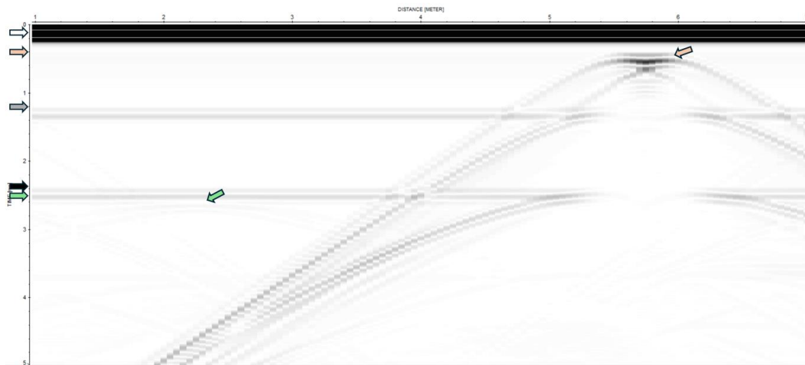
Εικόνα 4.26: Συνθετική καταγραφή σταθερής απόστασης πηγής-δέκτη (shot gather) τύπου wiggle plot, για τον συνδυασμό των M.3.1.c και M.3.1.abc.
