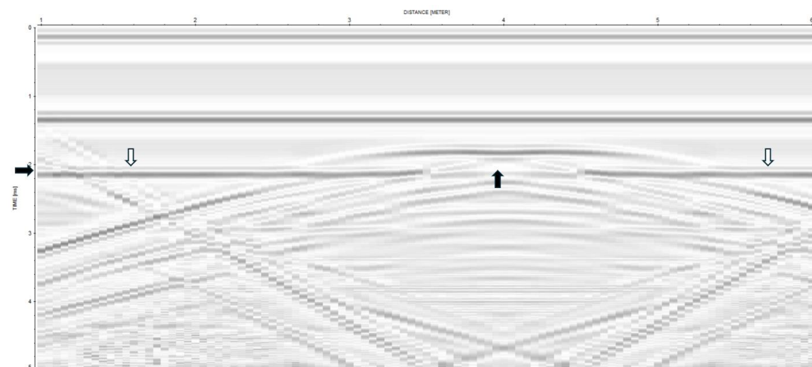
Εικόνα 4.45: Ενισχυμένη καταγραφή του M.3.1.bc με τις εξής τιμές: διάρκεια χρονικού παραθύρου=0.5 ms και ενίσχυση σήματος=0.1.
