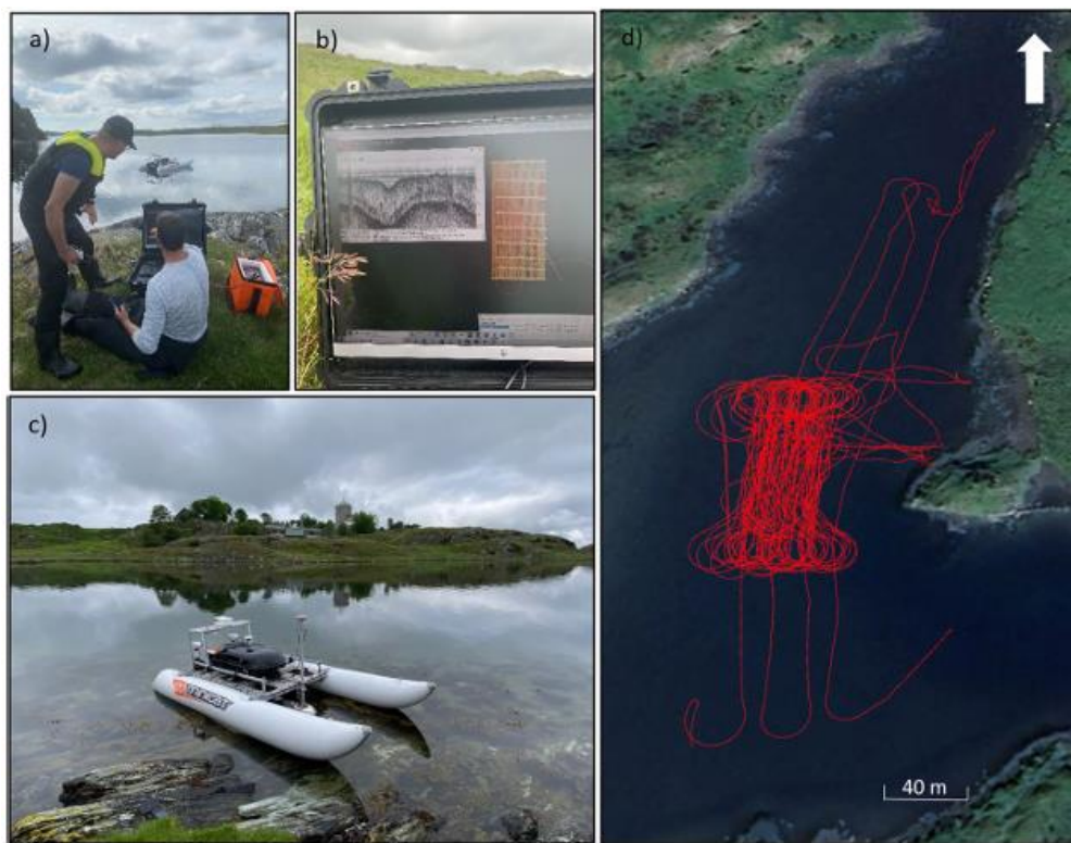
Εικόνα 3.22: (a) Ο χερσαίος σταθμός. (b) Οθόνη που δείχνει τη σεισμική καταγραφή, μαζί με το προκατασκευασμένο πλέγμα για την έρευνα στα δεξιά. (c) Το αυτόνομο όχημα επιφανείας που χρησιμοποιείται για την απόκτηση δεδομένων έρευνας σε ρηχά νερά. (d) Γραμμές πλεύσης της έρευνας (Ravnås, et al., 2023).
