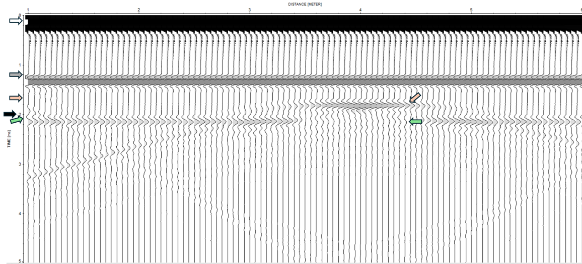
Εικόνα 4.18: Συνθετική καταγραφή σταθερής απόστασης πηγής-δέκτη (shot gather), τύπου wiggle mode για το μοντέλο M.3.1.bc.
