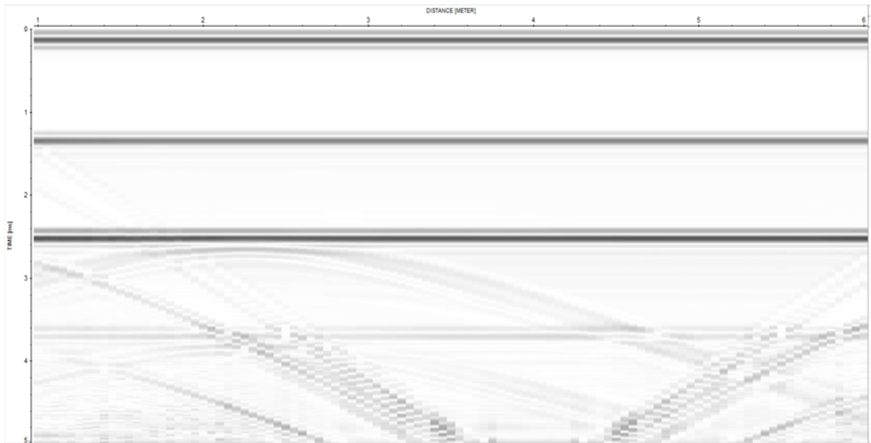
Εικόνα 4.33: Ενισχυμένη καταγραφή για το M.3.1.c με τις εξής τιμές: διάρκεια χρονικού παραθύρου=2 ms και ενίσχυση σήματος=0.01.
