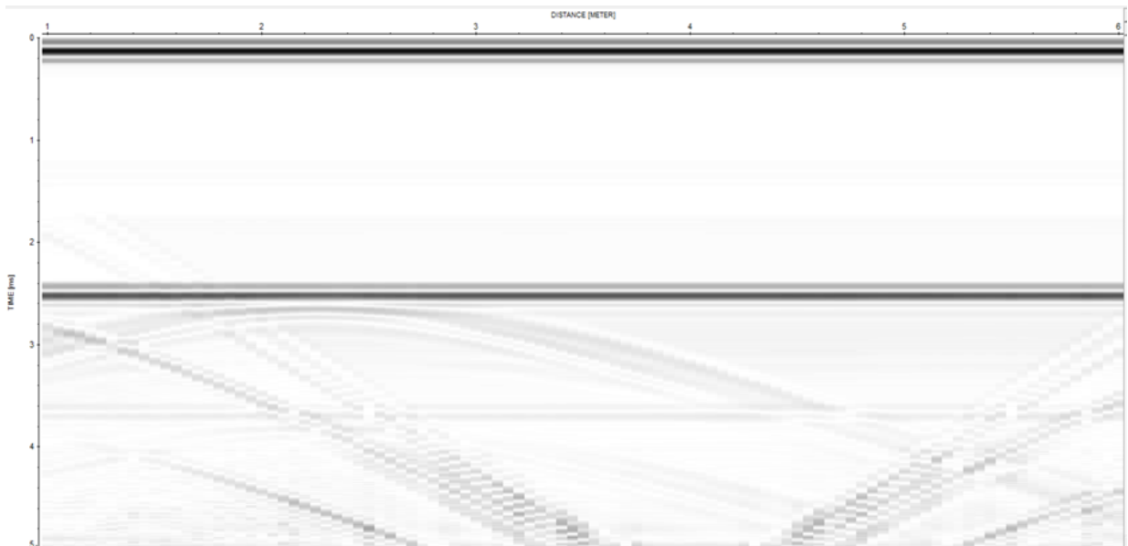
Εικόνα 4.34: Ενισχυμένη καταγραφή για το M.3.1.c με τις εξής τιμές: διάρκεια χρονικού παραθύρου=3 ms και ενίσχυση σήματος=0.01.
