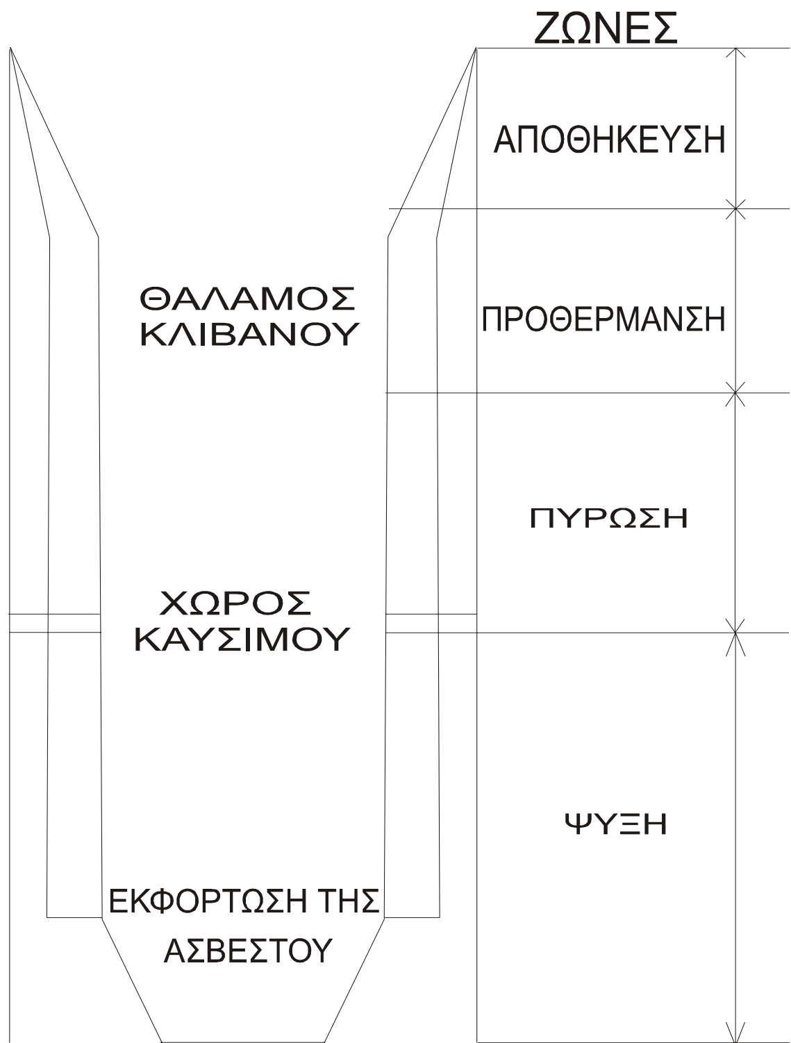
Σχήμα 3.1. Σχηματικό διάγραμμα ενός κατακόρυφου κλιβάνου (Boynton, 1980)
