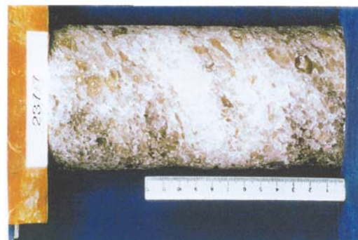
Εικόνα 4.4: Τα δοκίμια 237/7 και 237/8 πριν και μετά τις εργαστηριακές δοκιμές στις οποίες υπεβλήθησαν (IfG, 2000).
