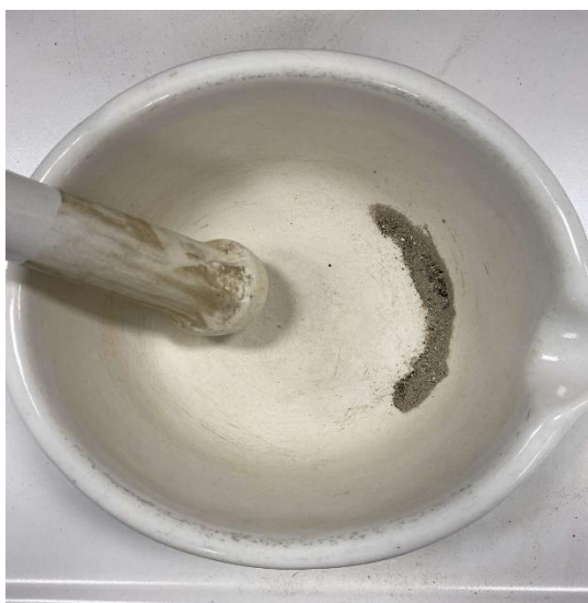
Εικόνα 3.6 Κατά τη διαδικασία που λειώνονται τα δείγματα στο γουδί
