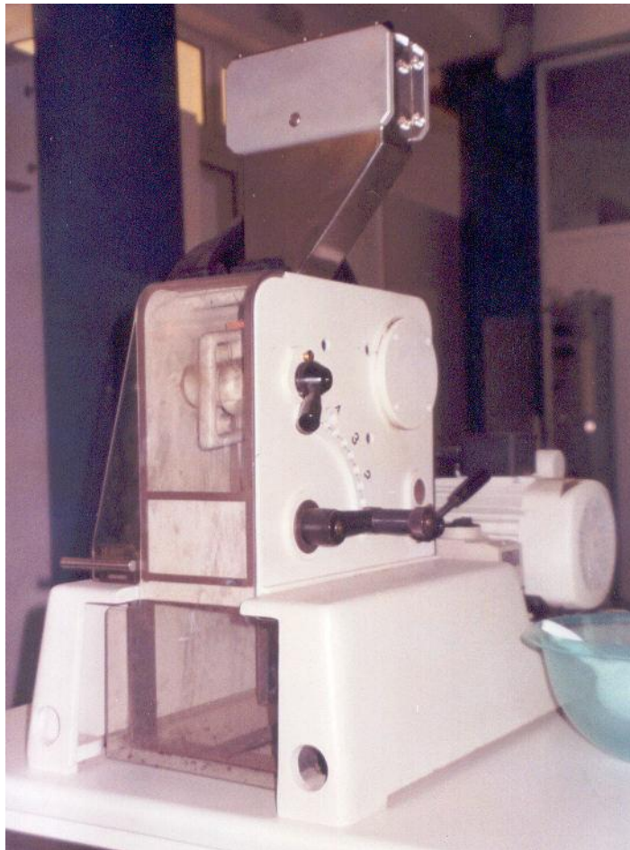
Σχήμα 3.5: Σιαγονωτός σπαστήρας.
