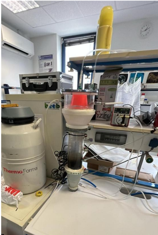
Σχήμα 11: Στην αριστερή εικόνα, ο αντιδραστήρας UASB μετά την προσθήκη ιλύς και πριν την έναρξη της περισταλτικής αντλίας. Στην δεξιά εικόνα, ο αντιδραστήρας λίγο πριν το τέλος του πειράματος.
