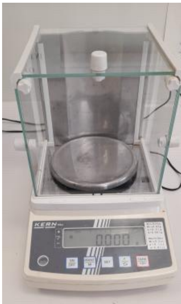
Σχήμα 15: Ζυγός ακριβείας (Kern ADB 200-4 Analytical balance)
