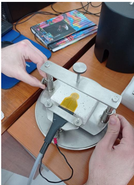
Εικόνα 5.10. Διαδικασία προετοιμασίας ανάλυσης θερμικών σταθερών.
