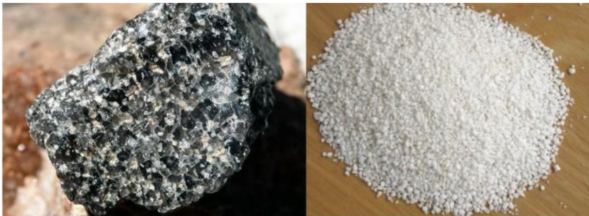
Εικόνα 3.2 Αριστερά: Φυσικός περλίτης. Δεξιά: Κατεργασμένος περλίτης.
