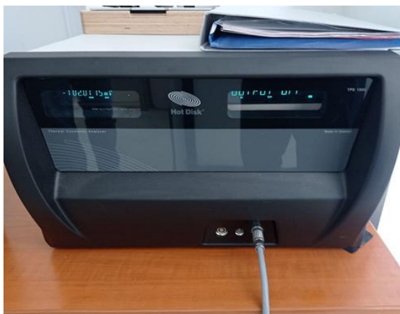
Εικόνα 5.9. Αναλυτής θερμικών σταθερών ζεστού δίσκου.
