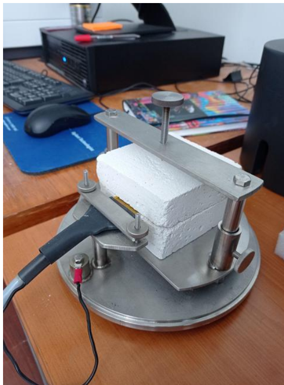
Εικόνα 5.11. Διαδικασία ανάλυσης θερμικών σταθερών.
