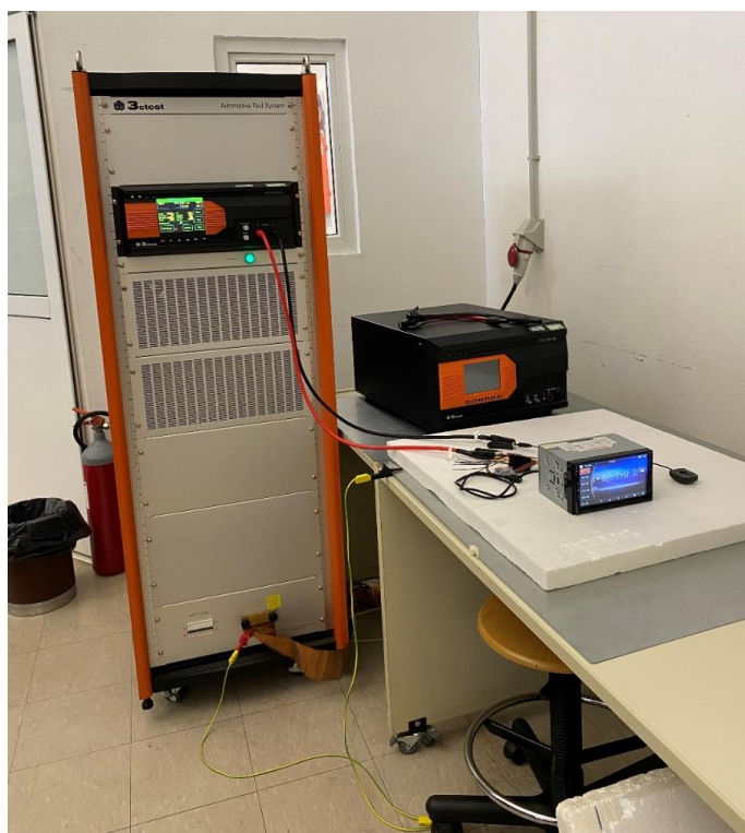
Figure 8. Συνδεσμολογία IVIS με γεννήτρια παραγωγής παλμών 2b, 4.
