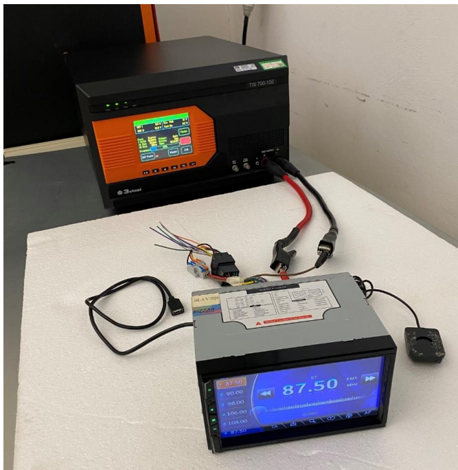
Figure 7. Συνδεσμολογία IVIS με γεννήτρια παραγωγής παλμών 1, 2a, 3a, 3b.
