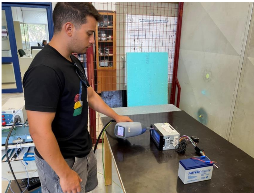
Figure 6. Εκτέλεση της δοκιμής ηλεκτροστατικής εκφόρτισης (ESD) στην μονάδα infotainment σύμφωνα με το πρότυπο IEC 61000-4-2, με χρήση ESD gun και τροφοδοσία από μπαταρία.
