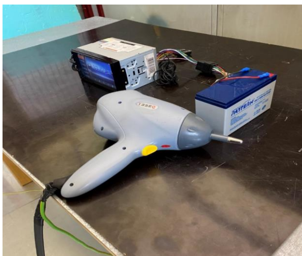
Figure 5. Πειραματική διάταξη δοκιμής ηλεκτροστατικής εκφόρτισης (ESD) της μονάδας infotainment με χρήση ESD gun και με τροφοδοσία μπαταρίας.
