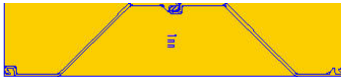
Σχήμα 3.5: Πασσαλοσανίδες συνδεδεμένες, σχήματος-Z (FAD, 2003)
