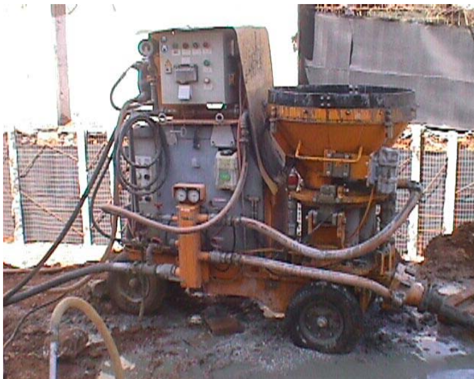
Φωτογραφία 4.17: Σύστημα ανάμιξης σκυροδέματος – μπεντονίτη.
