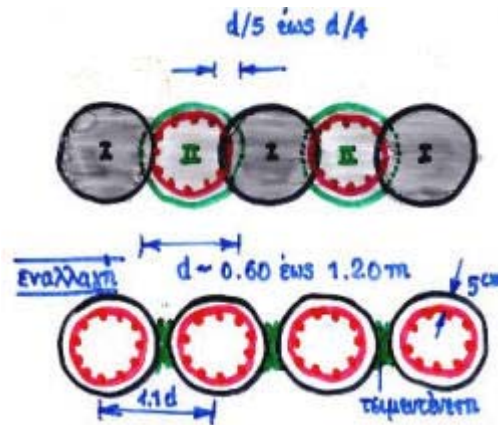
Σχήμα 3.7: Τυπική μορφή ενός πασσαλοδιαφράγματος (Κωστόπουλος, 1998)
