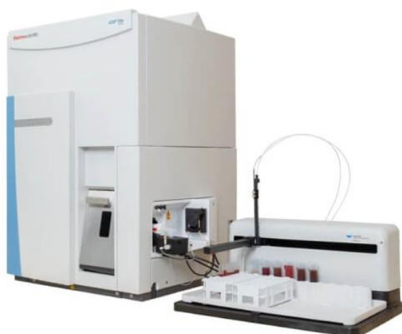
Εικόνα 2.4: Σύστημα φασματοσκοπίας μάζας με επαγωγικά συζευγμένο πλάσμα (ICP-MS) για ακριβή ανάλυση Agilent 7900 ICP-MS
