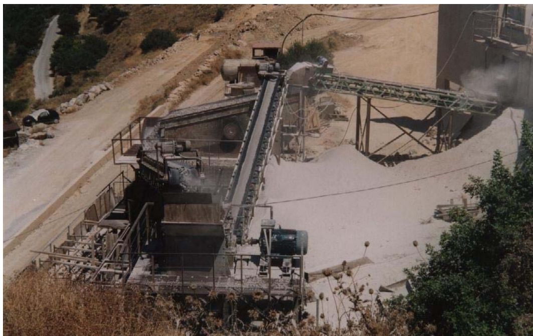
Σχήμα 3.6: Κύκλωμα θραύσης και ταξινόμησης του λατομείου Μανδηλαρά.
