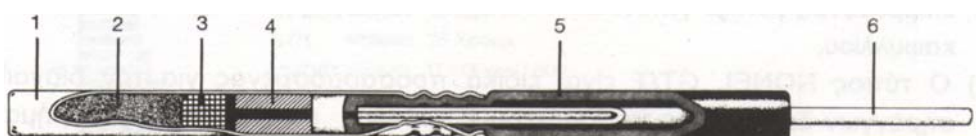
Σχήμα 2.5: Διαμήκης τομή καψυλίου NONEL (Τσουτρέλης, 1997)
