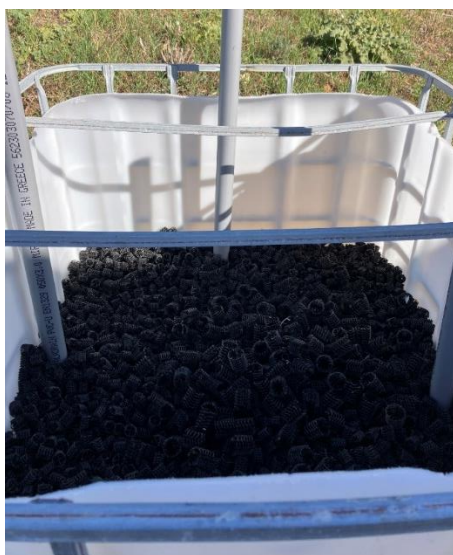
Εικόνα 3: Δεξαμενής (PP) την ώρα της τοποθέτησης Ανακυκλωμένου HDPE, Αύγουστος 2023
