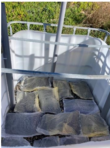
Εικόνα 2: Δεξαμενής (PGB) την ώρα της τοποθέτησης του βιοεξανθρακώματος, Αύγουστος 2023
