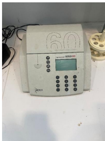
Εικόνα 6: Αντιδραστήρια υπολογισμού Ολικού Αζώτου | Εικόνα 7: Συσκευή Υπολογισμού ολικού Αζώτου
